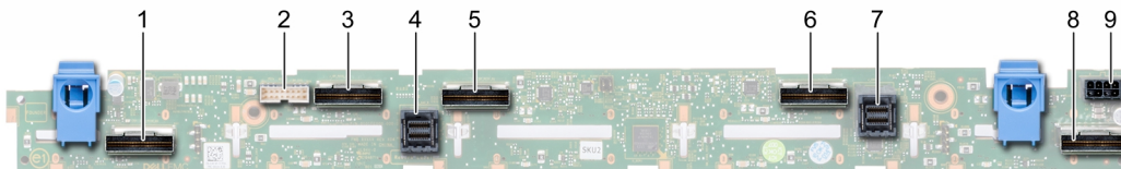
図 72.2.5 インチ SAS、SATA、NVMe ドライブバックプレーン 10 台
