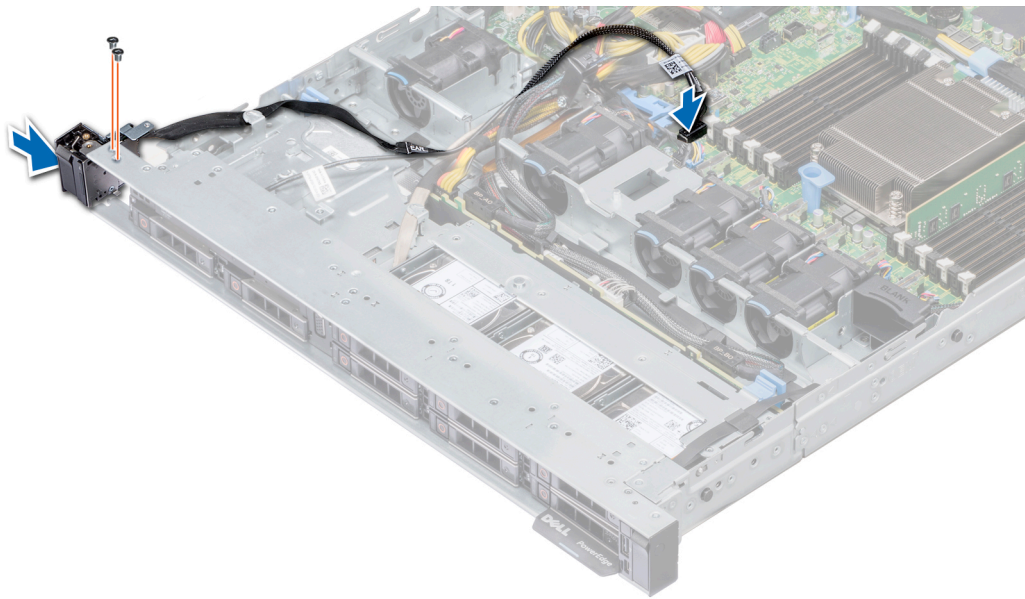
Figure 92. Installation du panneau de commandes gauche
