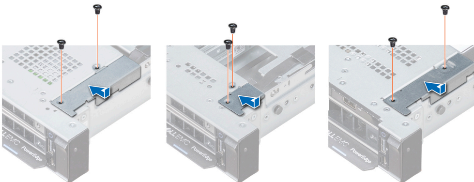
Figure 96. Installation du cache-câbles
