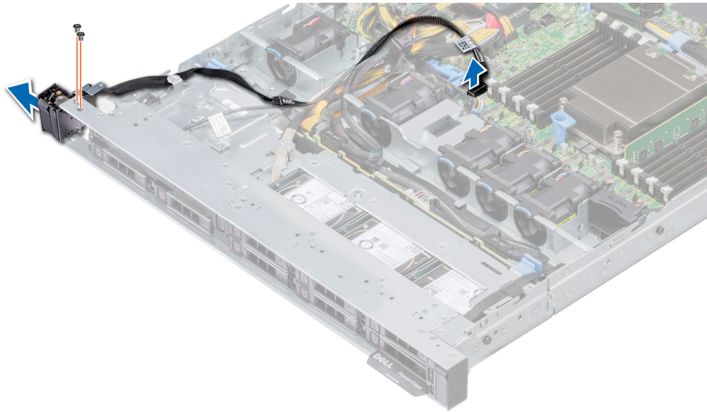
Figure 91. Retrait du panneau de commandes gauche
