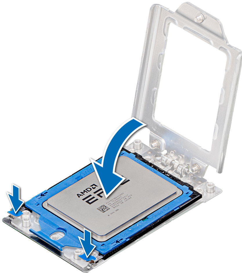
Figure 49. Fermeture du cadre de support du processeur
