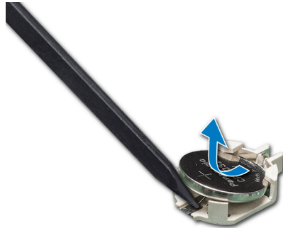
Figure 79. Retrait de la pile du système
