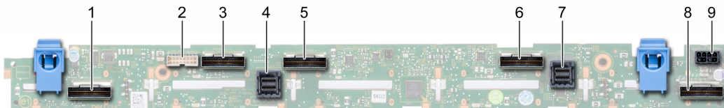
Figure 72. Fond de panier pour 10 disques SAS, SATA ou NVMe de 2,5 pouces
