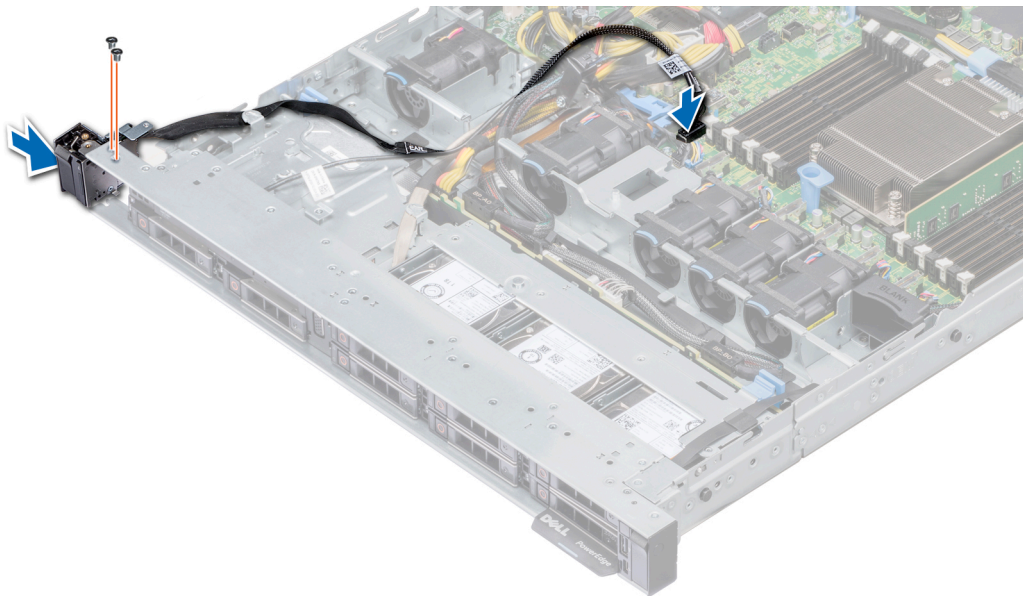
Figure 92. Installation du panneau de commandes gauche
