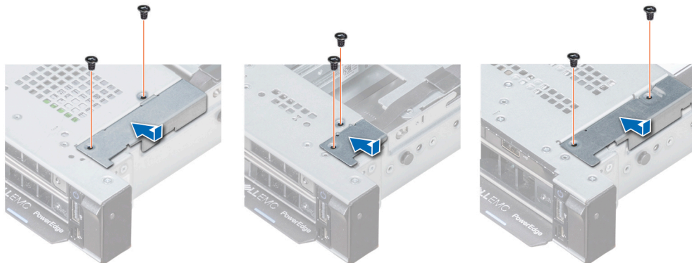
Figure 96. Installation du cache-câbles
