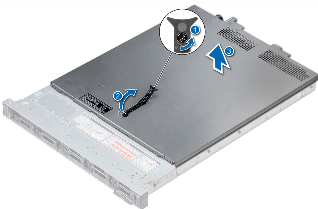
Figure 24. Retrait du capot du système
