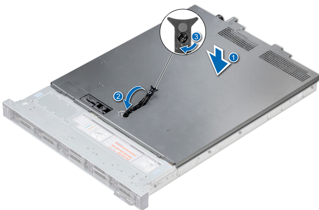
Figure 25. Installation du capot du système
