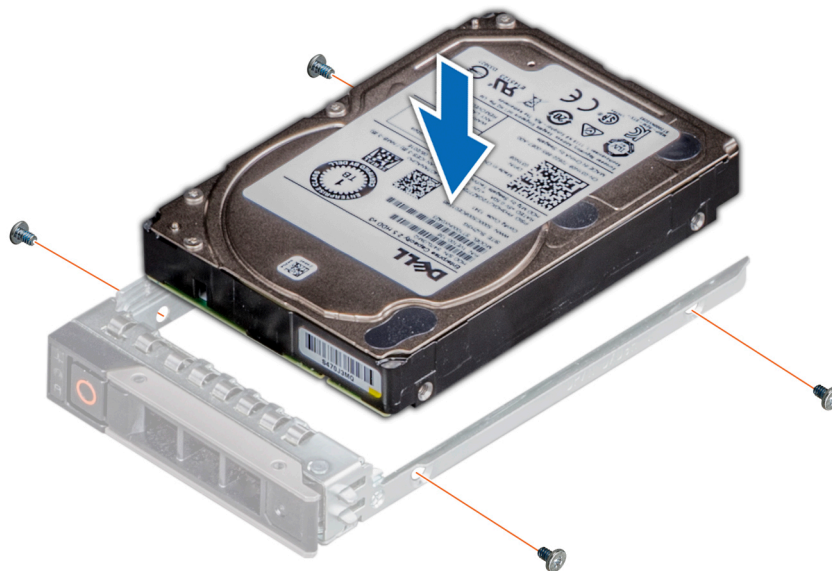
Figura 40. Instalación de una unidad de disco duro en la portadora de disco duro
