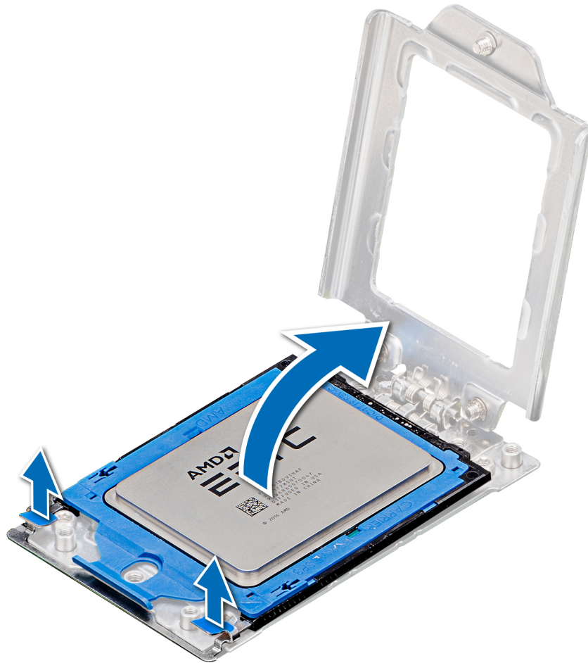
Figura 46. Levantamiento del marco del riel
