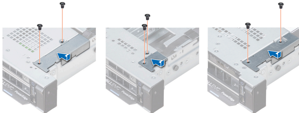
Figura 96. Instalación de la cubierta de cables
