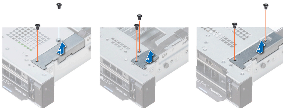
Figura 93. Extracción de la cubierta de cables
