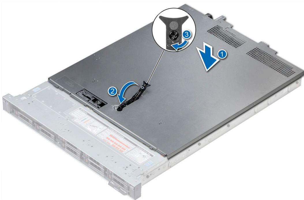
Figura 25. Instalación de la cubierta del sistema
