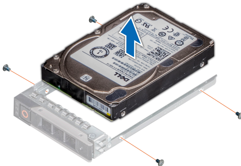
Figura 39. Extracción de la unidad de la portadora de disco duro
