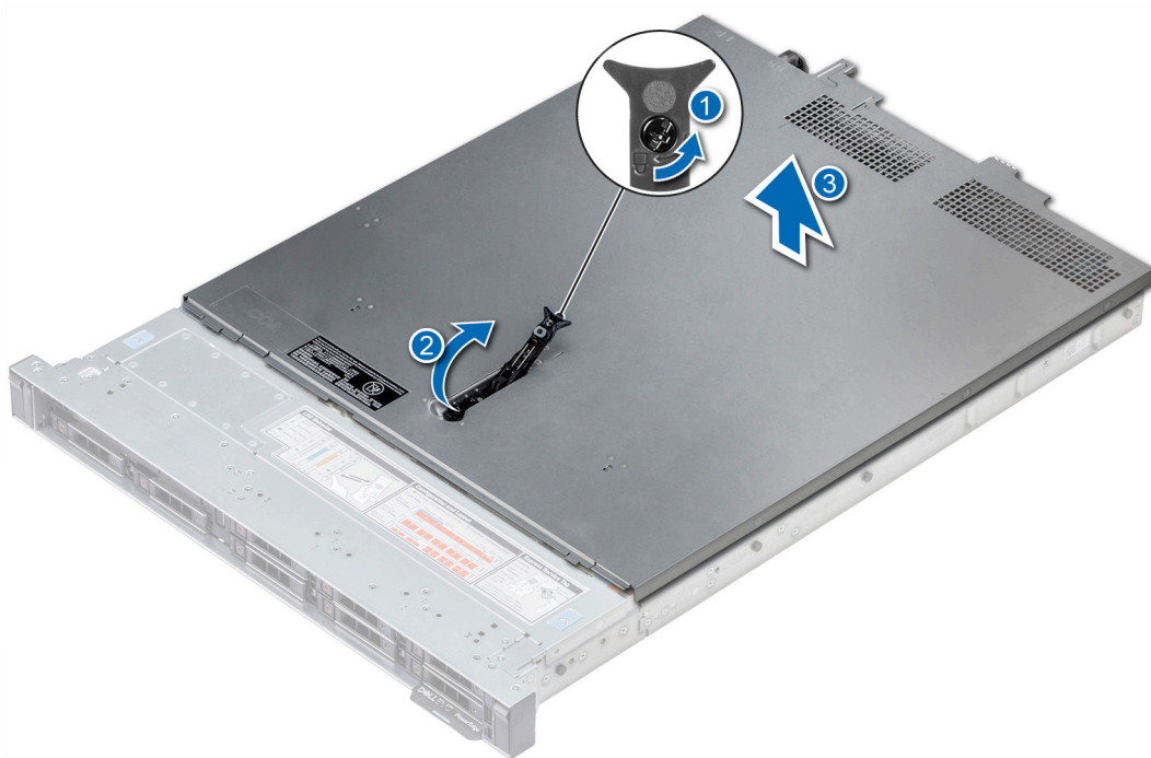
Figura 24. Extracción de la cubierta del sistema
