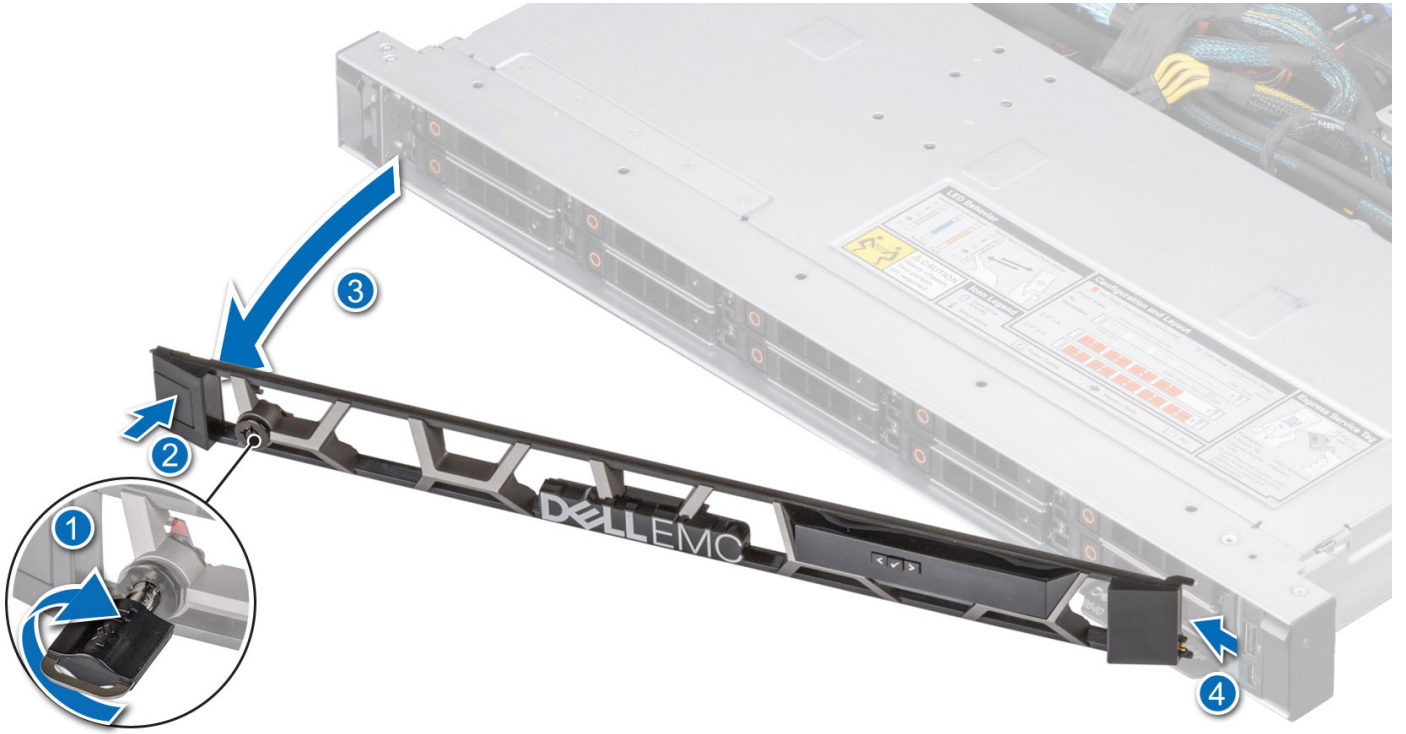
Rakam 15. LCD panelli ön çerçeveyi çıkarma
