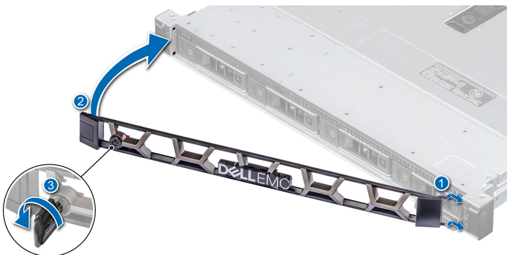
図 14. オプションの前面ベゼルの取り付け
