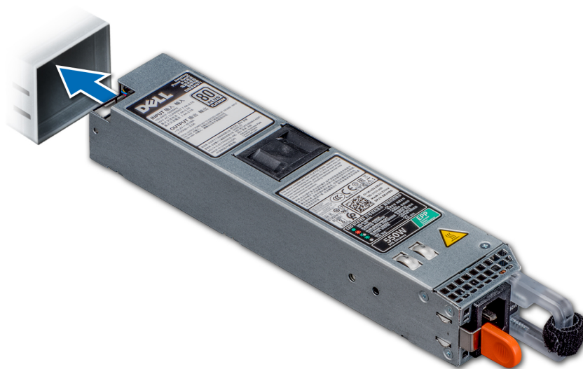
図 71. 電源供給ユニットの取り付け
