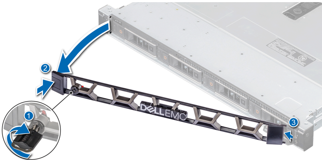
図 13. オプションの前面ベゼルの取り外し
