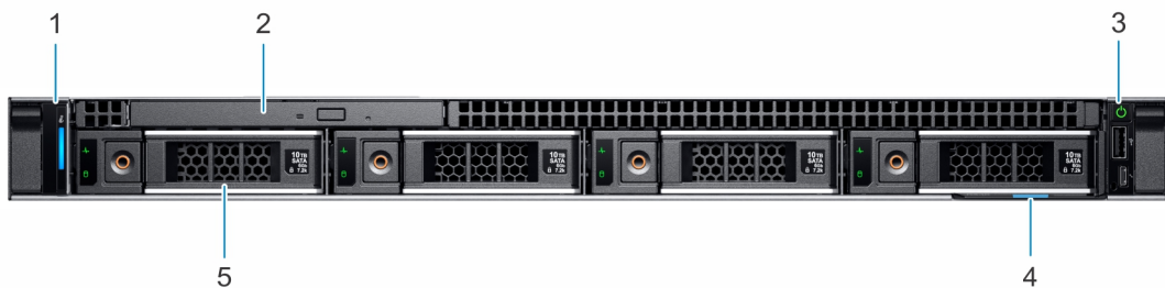
図 2. 4x3.5 インチ ドライブ システムの前面図
