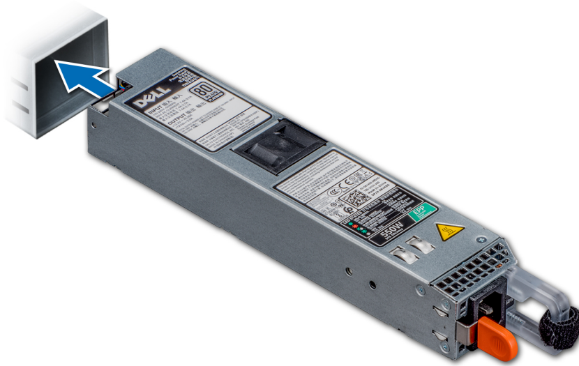
Figure 71. Installation d'un bloc d'alimentation
