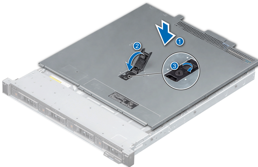
Ilustración 16. Instalación de la cubierta del sistema
