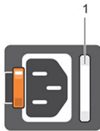
Ilustración 85. Indicador de estado de la unidad de fuente de alimentación de CA
