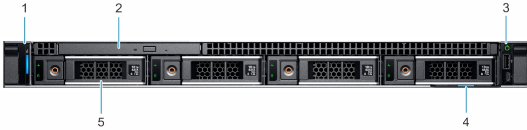
그림 2. 4개의 8.89cm(3.5인치) 드라이브 시스템의 전면
