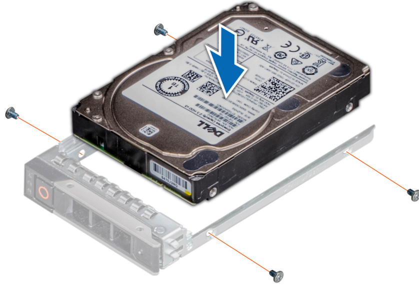
Rakam 33. Sürücü taşıyıcısına sürücü takma
