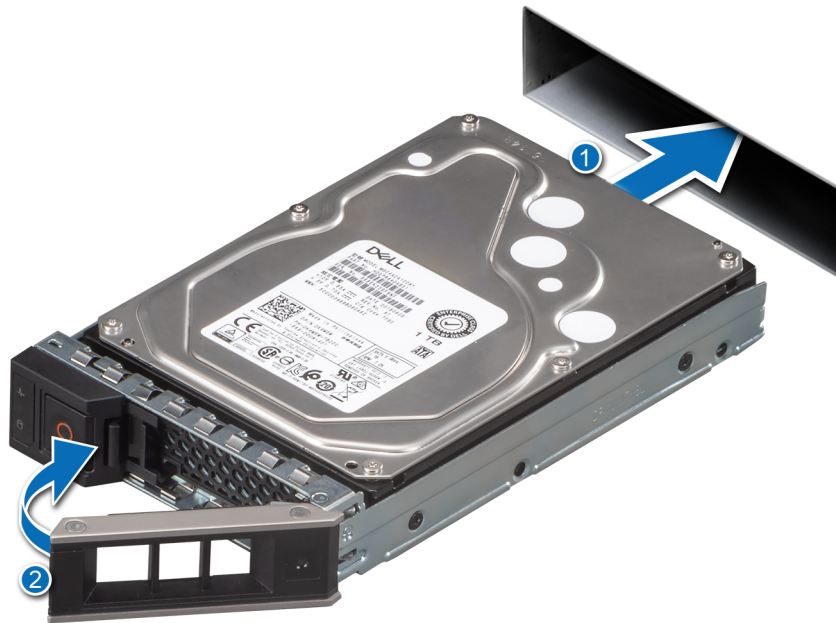
Ilustración 22. Instalación de la unidad de intercambio activo
