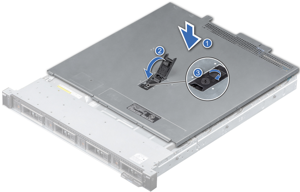
Ilustración 12. Instalación de la cubierta del sistema
