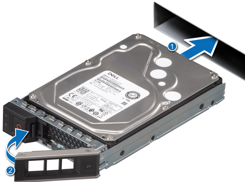
Abbildung 22. Einbauen des Hot-Swap-fähigen Laufwerks
