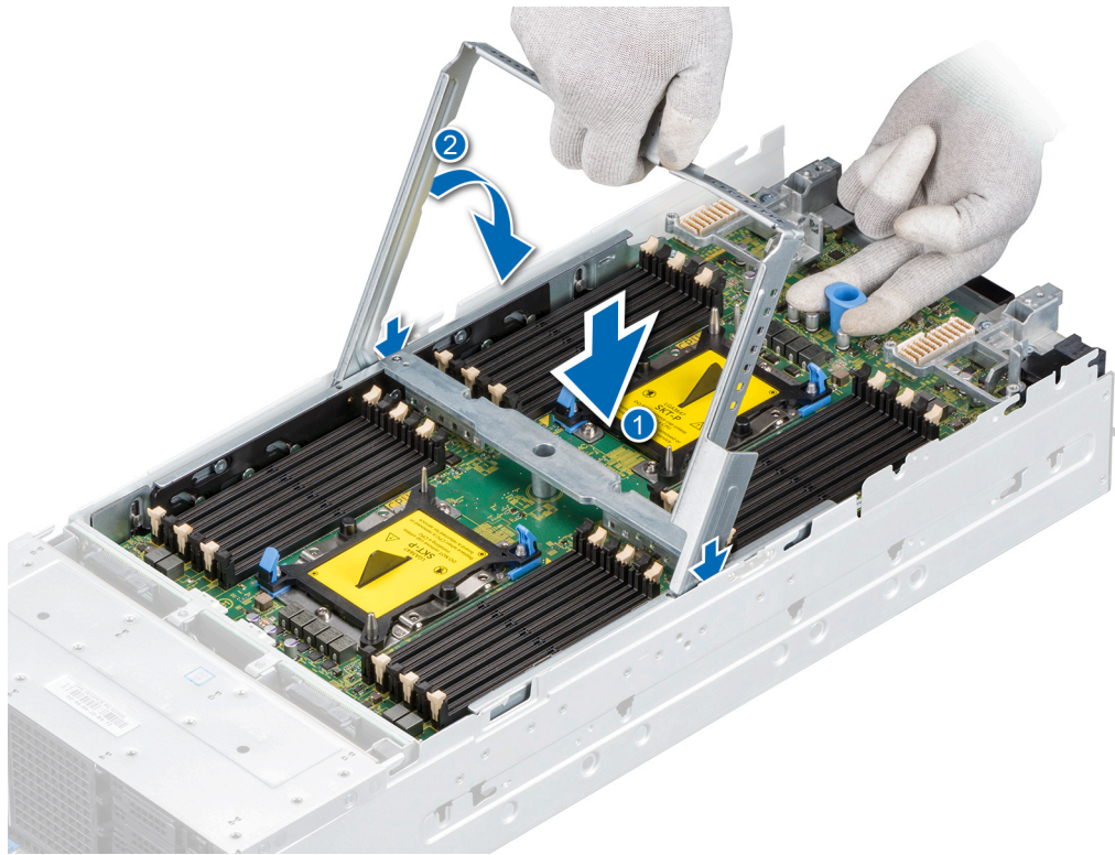
図 24. PEM の取り付け
