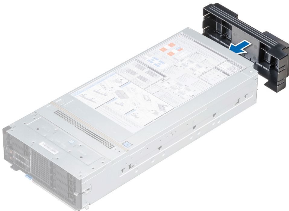
Figure 14. Installation du cache du connecteur d'E/S sur le traîneau
