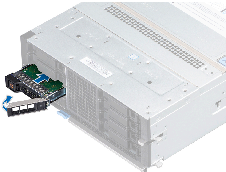
Figure 28. Installation d'un support de disque dur
