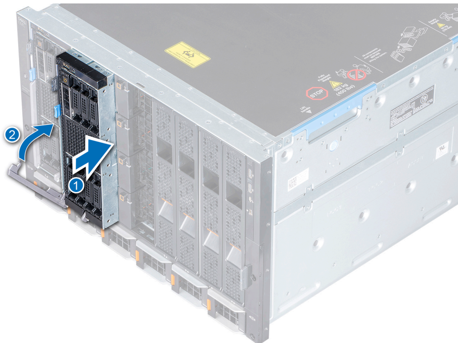
Figure 16. Installation du traîneau dans le boîtier
