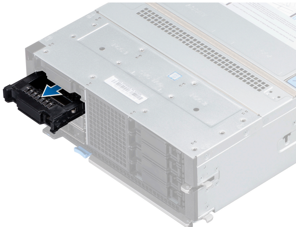
Figure 25. Retrait d'un cache de disque
