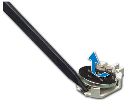
Figure 86. Retrait de la pile du système
