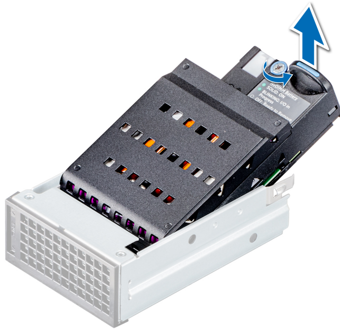
Figure 47. Retrait du bloc de batterie de secours du bâti correspondant
