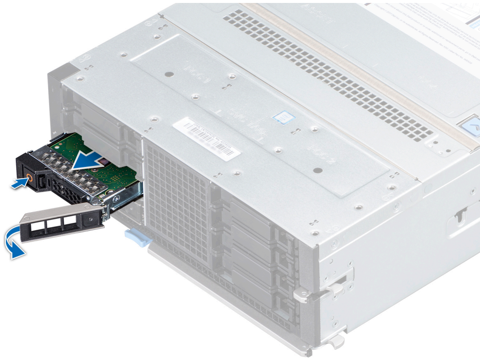
Figure 27. Retrait d'un support de disque dur
