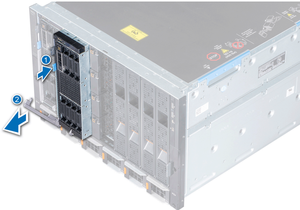
Figure 13. Retrait du traîneau du boîtier
