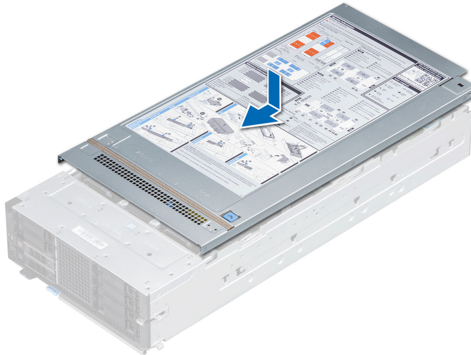
Figure 18. Installation du cache du chariot
