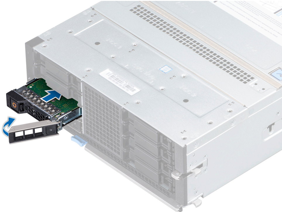
Figure 28. Installation d'un support de disque dur
