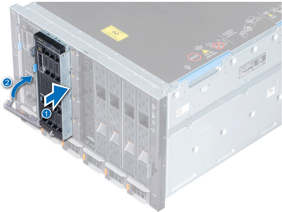
Figure 16. Installation du traîneau dans le boîtier
