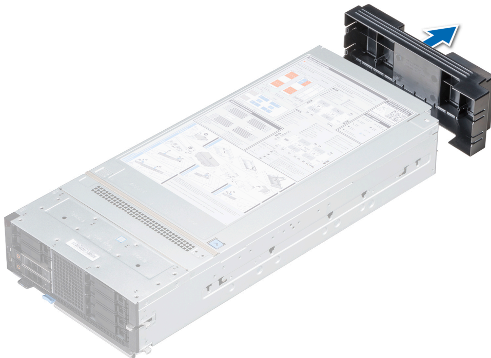
Abbildung 15. Entfernen der E/A-Anschlussabdeckung vom Schlitten
