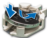
Abbildung 87. Installieren der Systembatterie
