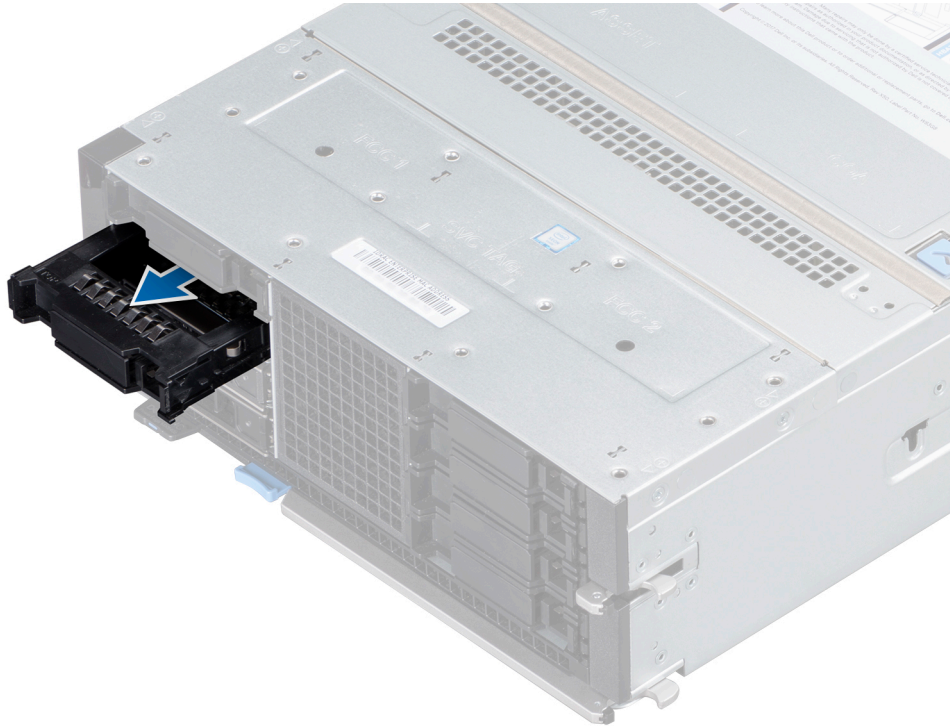
Abbildung 25. Entfernen eines Laufwerkplatzhalters
