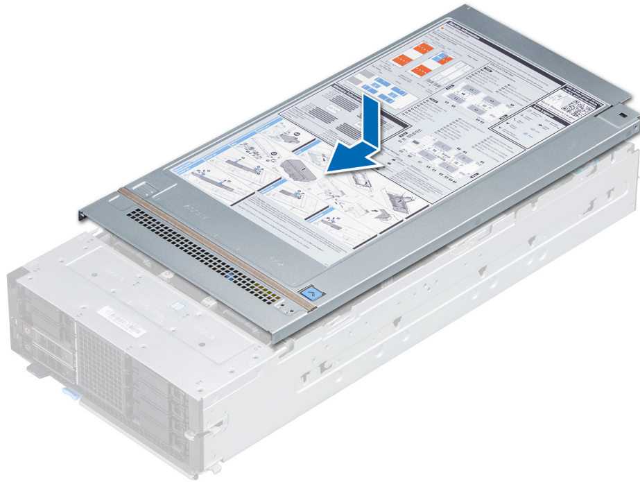
Abbildung 18. Anbringen der Schlittenabdeckung
