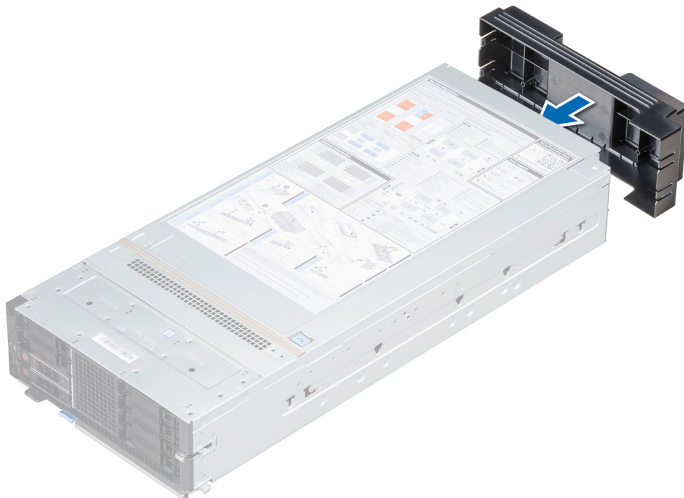
Abbildung 14. Installieren der E/A-Anschlussabdeckung am Schlitten
