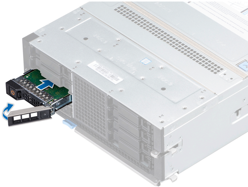
Abbildung 28. Einsetzen eines Laufwerksträgers
