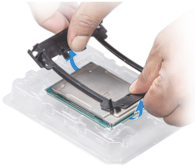
Abbildung 57. Entfernen der Prozessorhalterung
