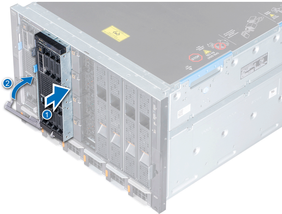
Abbildung 16. Einsetzen des Schlittens in das Gehäuse
