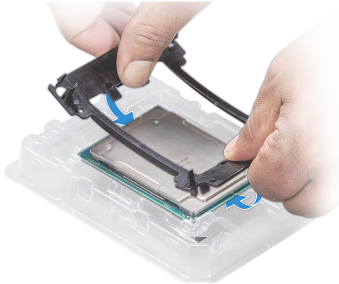
Abbildung 58. Installieren der Prozessor-Halterung
