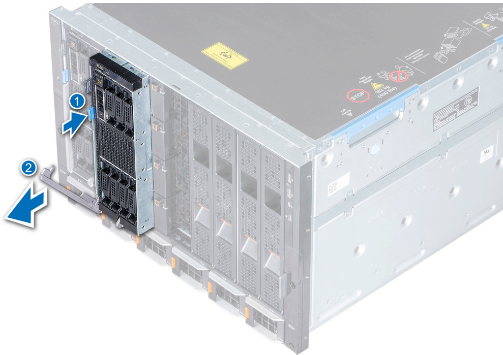
Abbildung 13. Entfernen des Schlittens aus dem Gehäuse
