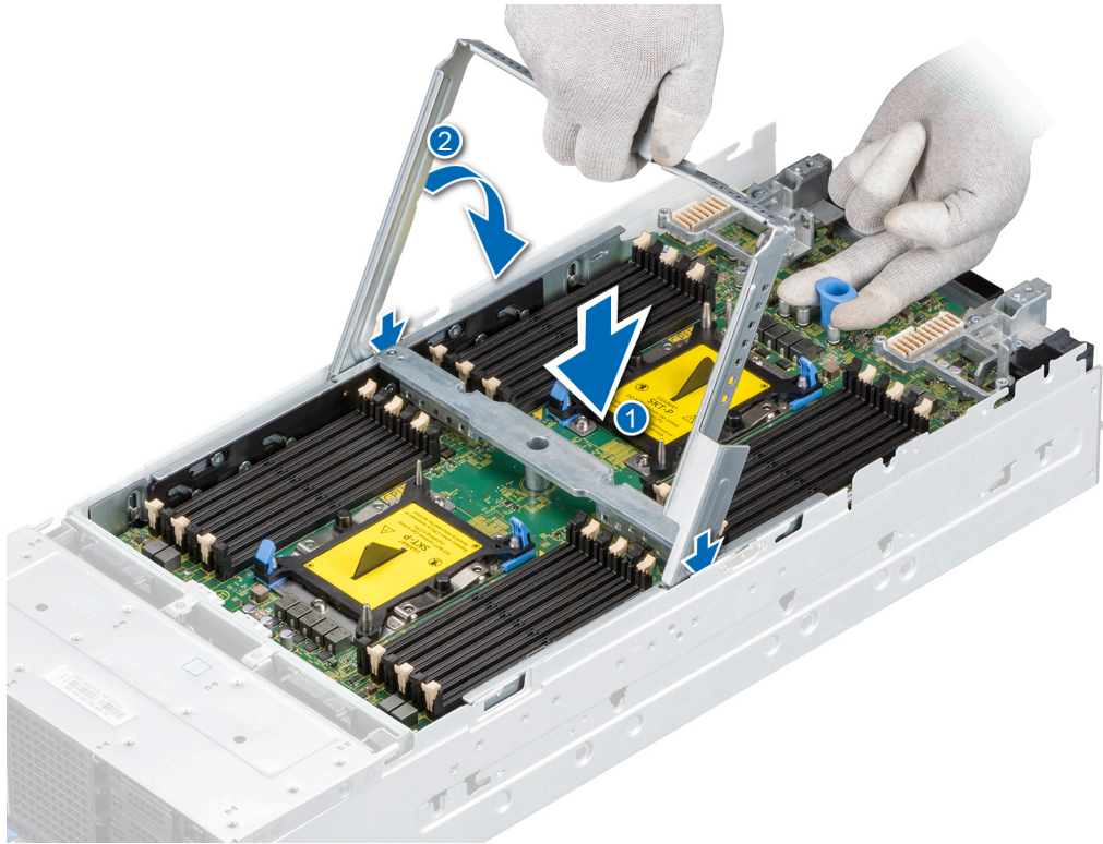
Abbildung 24. Einsetzen der PEM
