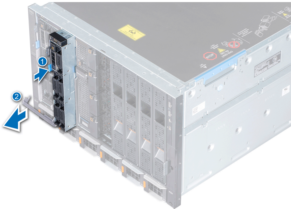
Figure 11. Retrait du traîneau du boîtier.
