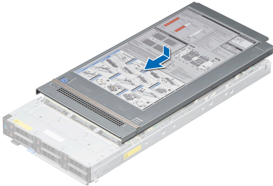
Figure 16. Installation du cache de traîneau
