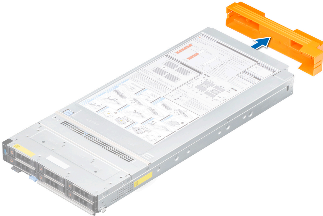
Figure 13. Retrait du cache du connecteur d'E/S du traîneau.
