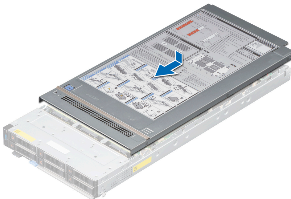
Ilustración 16. Instalación de la cubierta del sled
