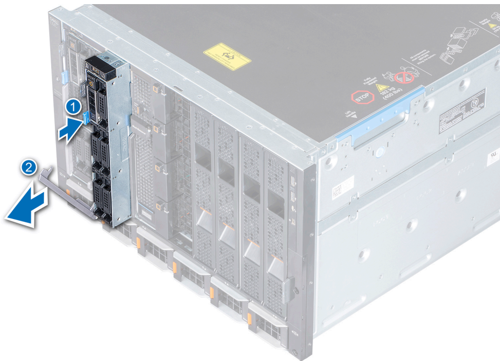
Ilustración 11. Extracción del sled del gabinete.
