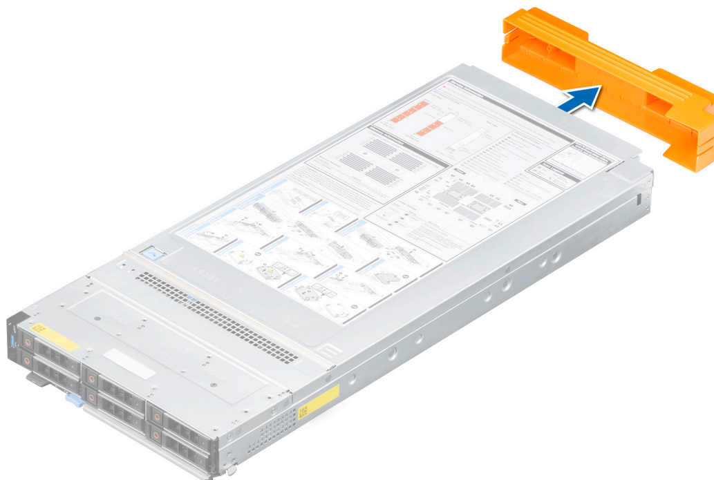
Ilustración 13. Extracción de la cubierta del conector de I/O del sled
