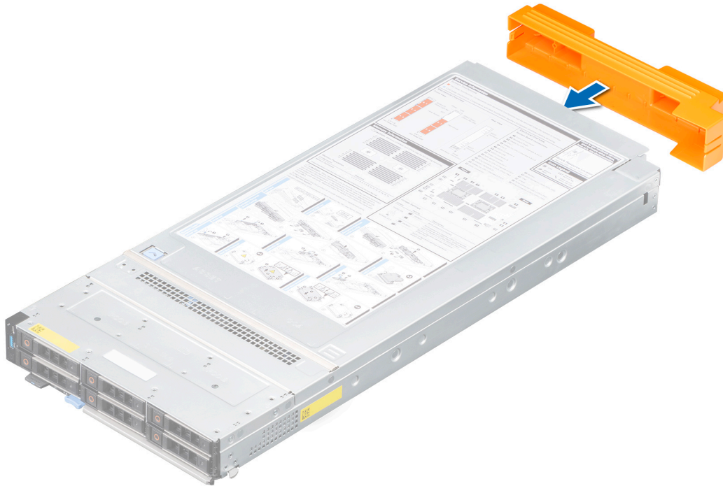
Ilustración 12. Instalación de la cubierta del conector de I/O en el sled
