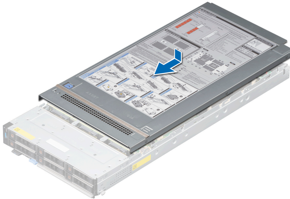
Abbildung 16. Installieren der Schlittenabdeckung
