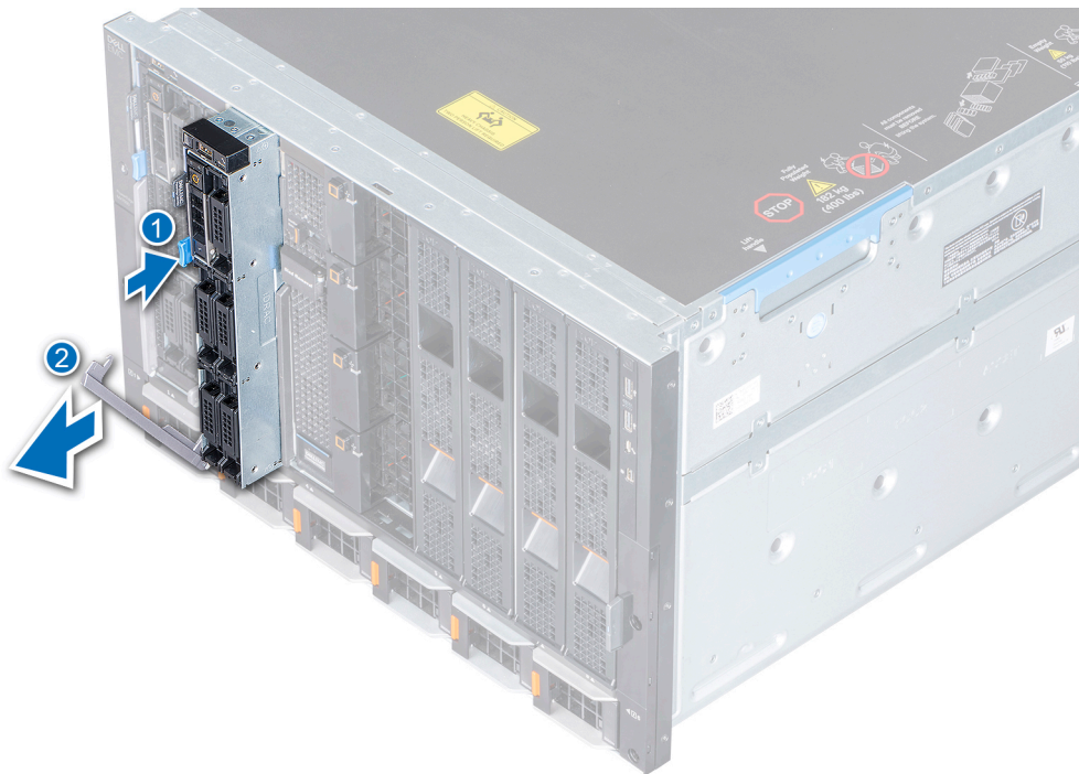
Abbildung 11. Entfernen des Schlittens aus dem Gehäuse.
