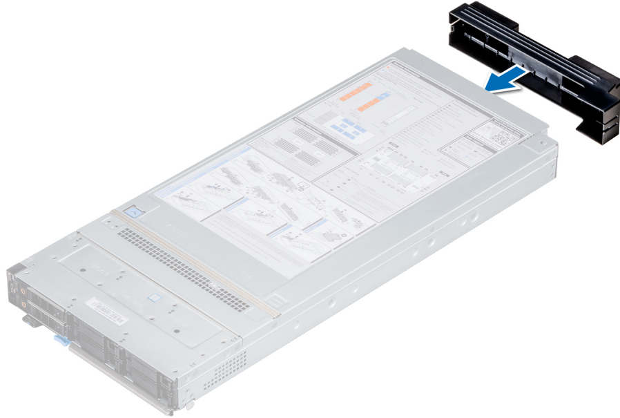
그림 13 . 슬레드에 I/O 커넥터 커버 설치
