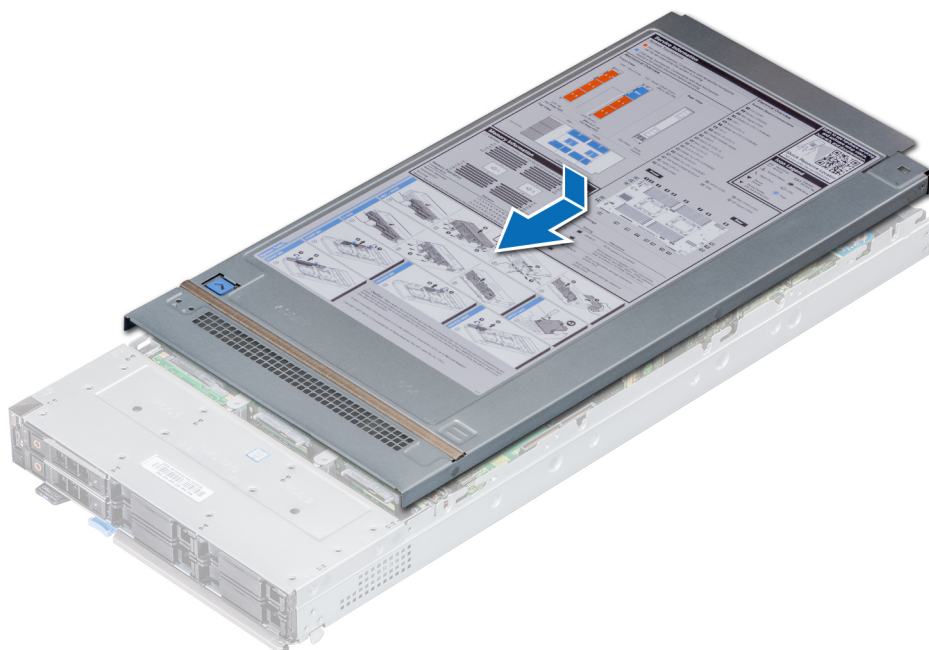
図 17. システムカバーの取り付け
