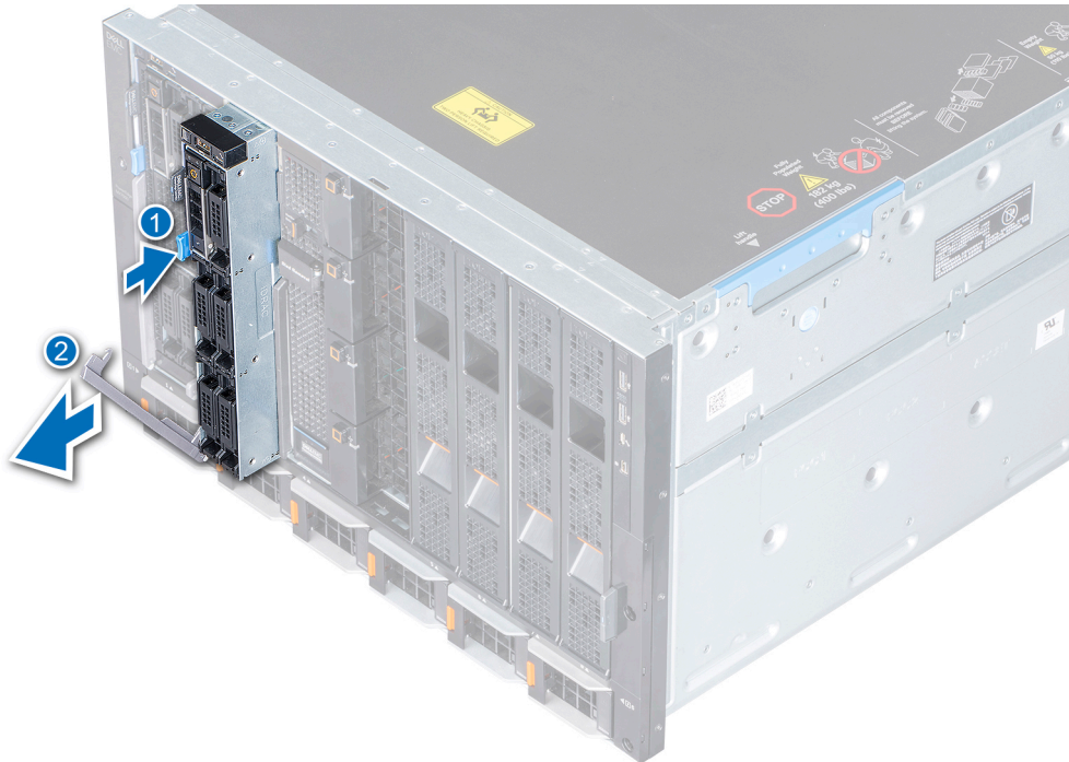
図 12. エンクロージャからのスレッドの取り外し
