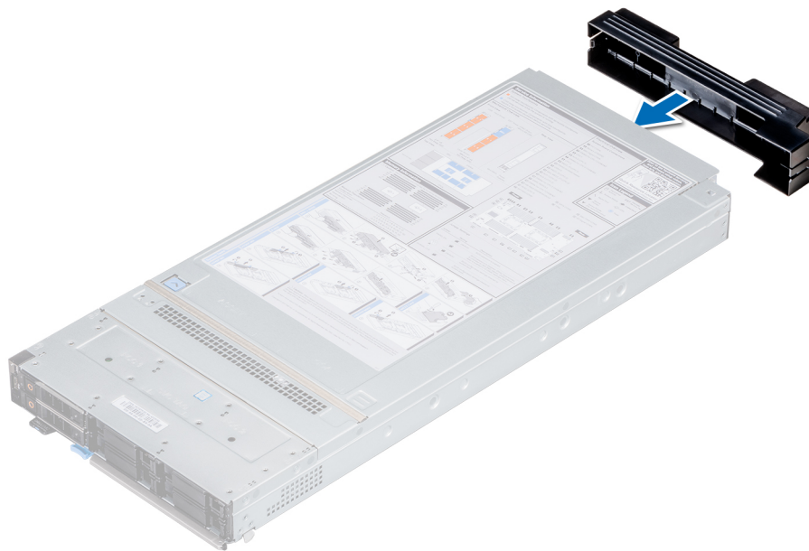
図 13. スレッドへの I/O コネクタ カバーの取り付け
