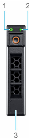
図 90. ドライブのドライブインジケータとミッドドライブトレイバックプレーン
