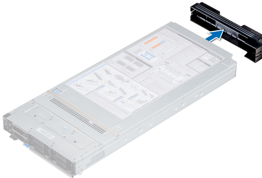
Figure 14. Retrait du cache de connecteur d'E/S du module tiroir extractible
