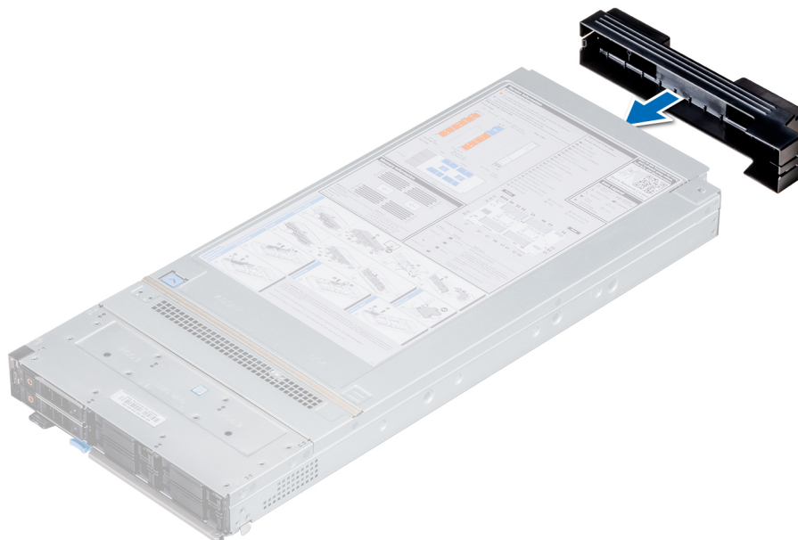
Figure 13. Installation du cache de connecteur d'E/S sur le module tiroir extractible
