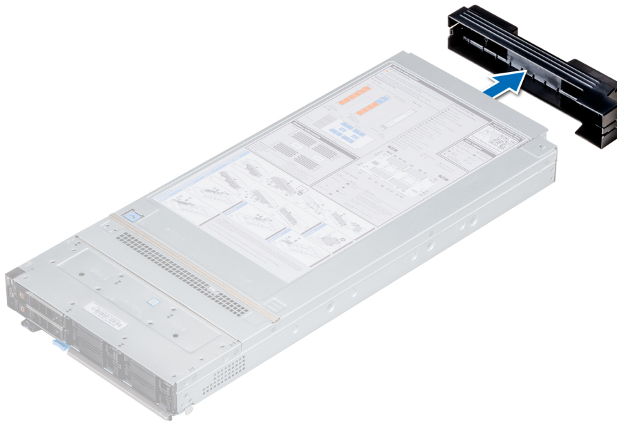
Ilustración 14. Extracción de la cubierta del conector de E/S del sled
