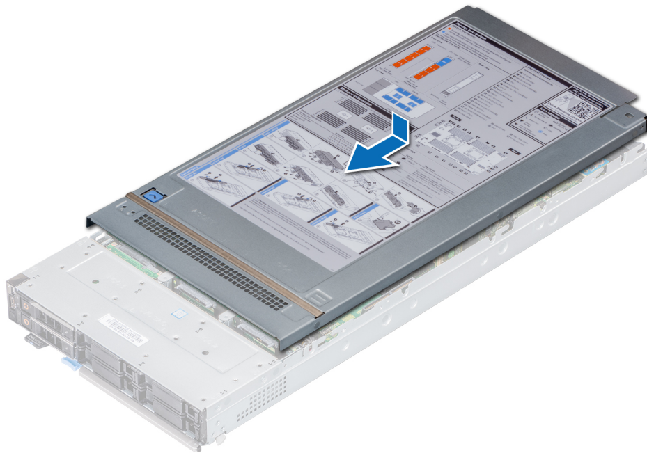
Abbildung 17. Installieren der Systemabdeckung
