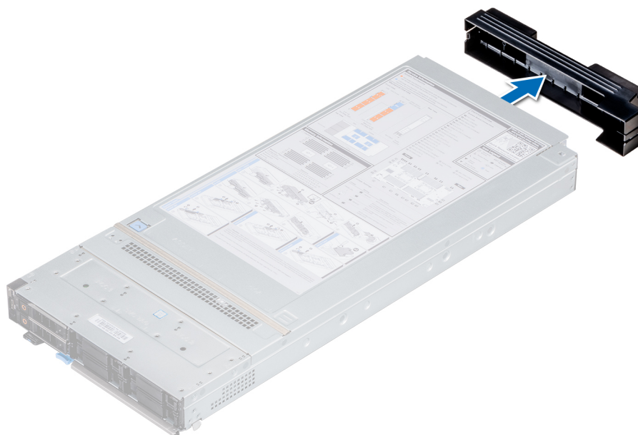
Abbildung 14. Entfernen der E/A-Anschlussabdeckung vom Schlitten
