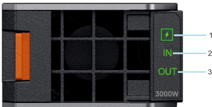
图 12: 直流电源的 PSU 指示灯
