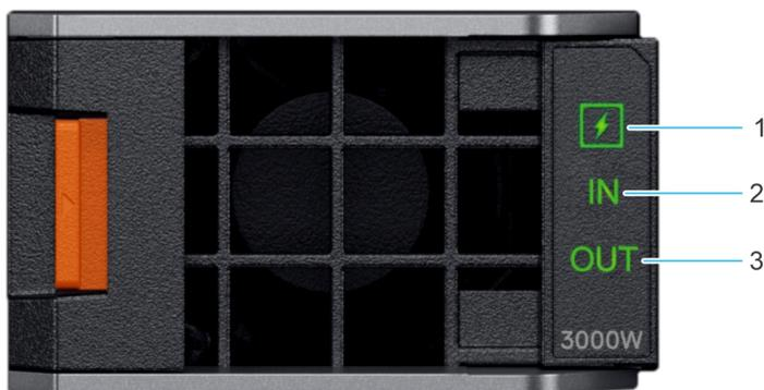
**Ilustración 12. Indicadores de la PSU para la fuente de alimentación de CC**
