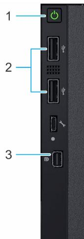
**Ilustración 4. Panel de control derecho**
