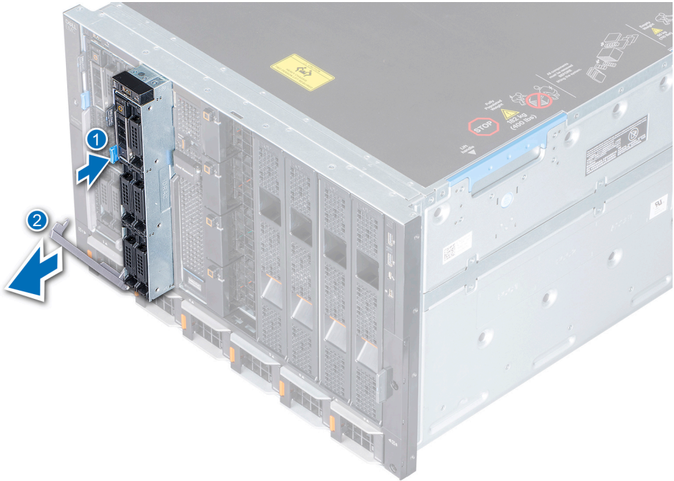
Rakam 16. Tek genişlikli bilgi işlem kızağını muhafazadan çıkarma
