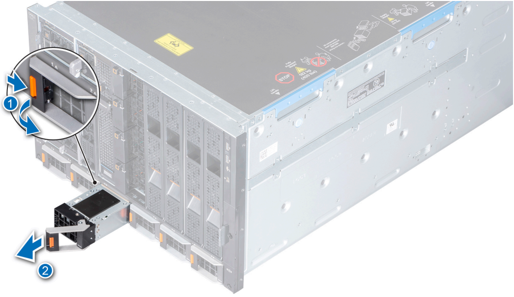
Rakam 24. Bir güç kaynağı ünitesini çıkarma
