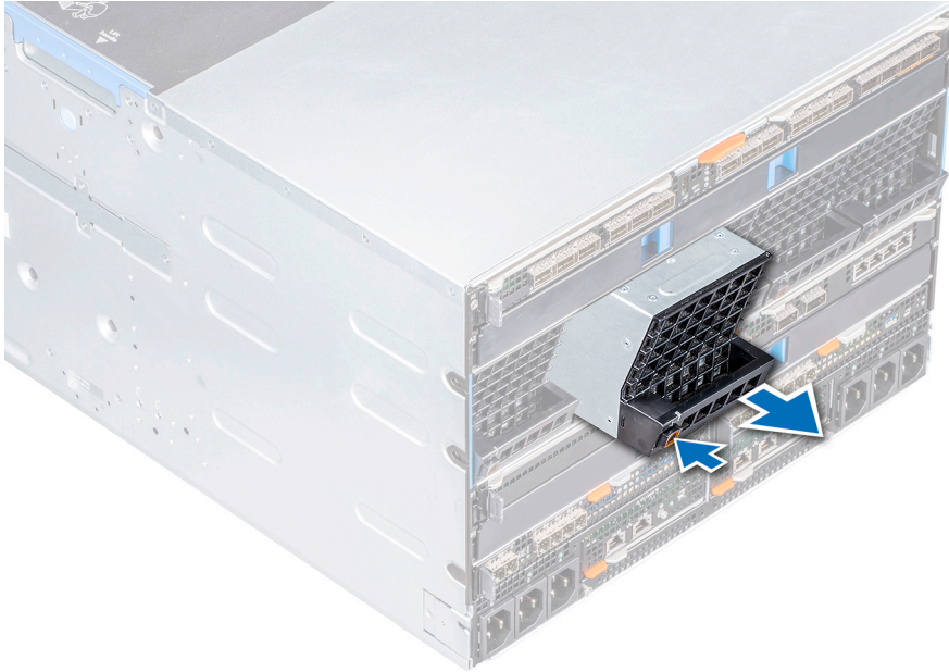
Rakam 22. Arka fan modülünü çıkarma
