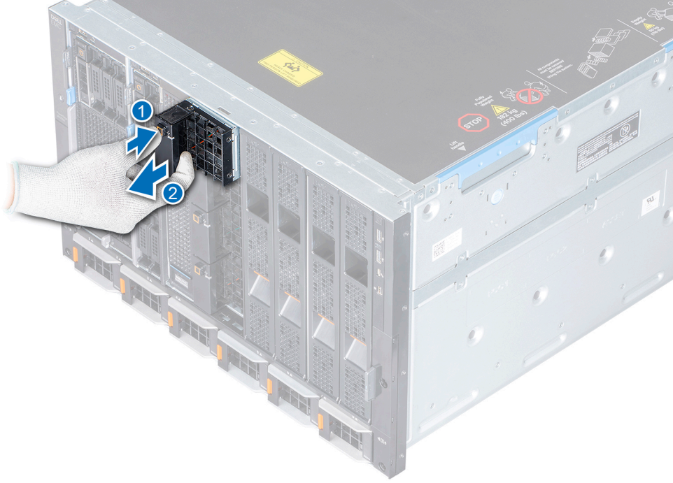
Rakam 20. Ön fan modülünü çıkarma
