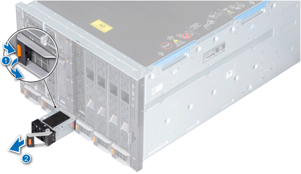
Rakam 24. Bir güç kaynağı ünitesini çıkarma
