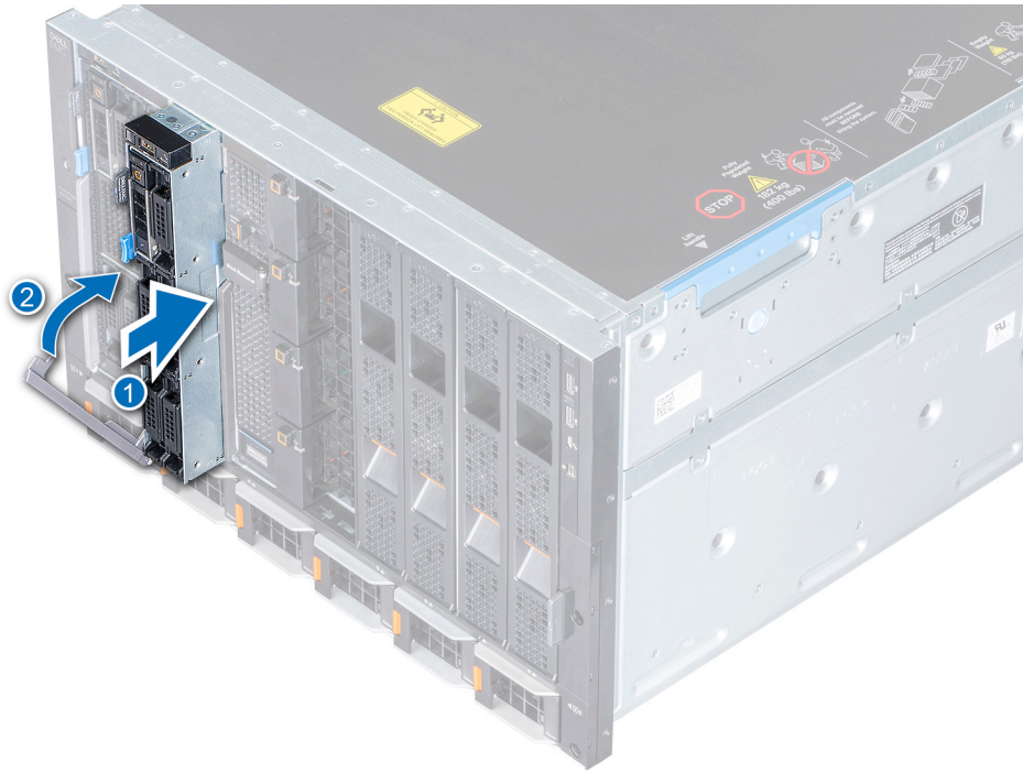
그림 18 . 엔클로저에 단일 노비 컴퓨팅 슬레드 설치
