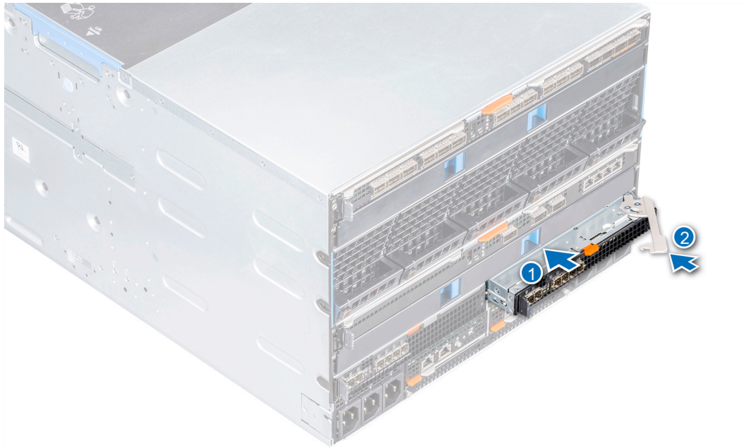
그림 35. 패브릭 C 슬롯에 MX7000 모듈 설치
