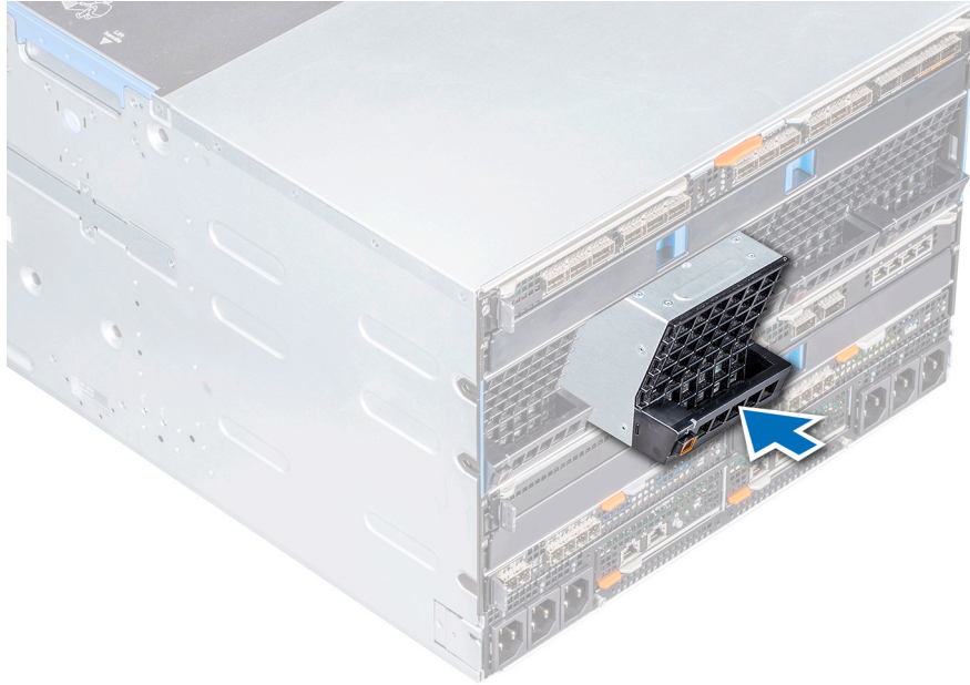
그림 23. 후면 팬 모듈 설치
