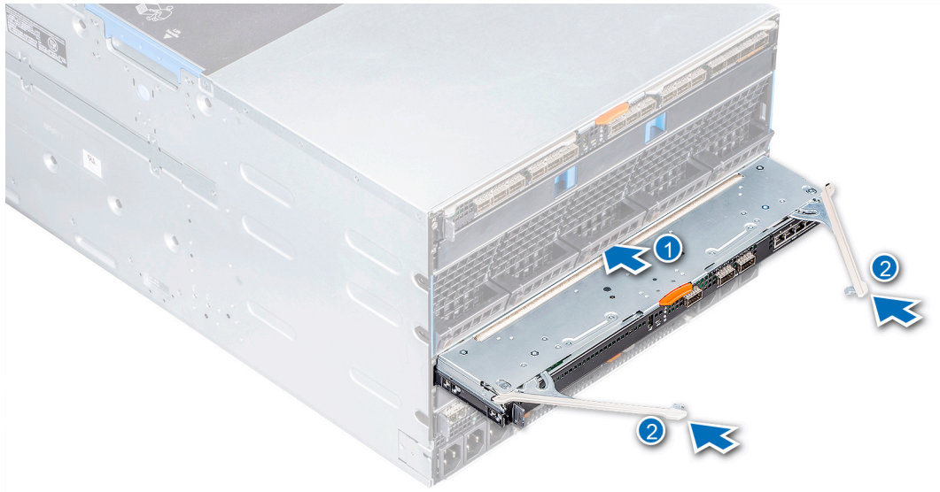
그림 31. 패브릭 A 또는 B 슬롯에 모듈 설치
