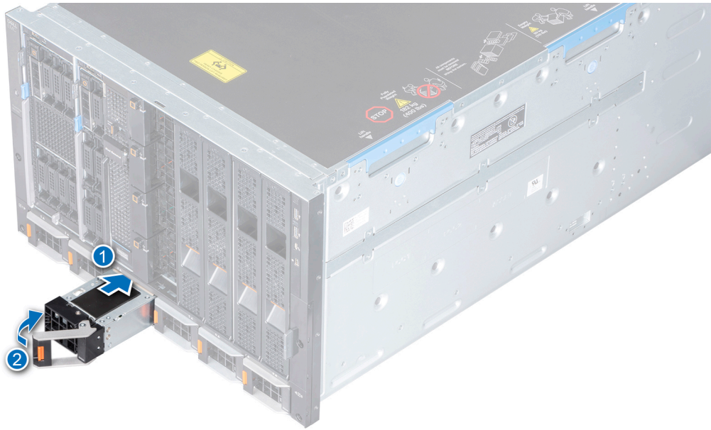
그림 25. 전원 공급 장치 설치
