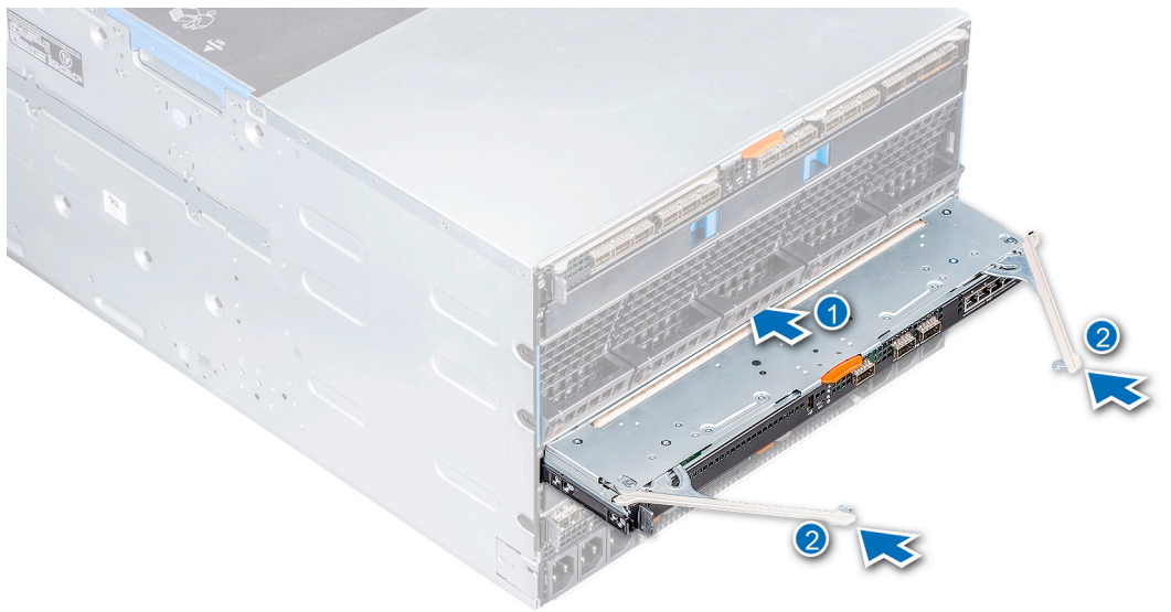
그림 31. 패브릭 A 또는 B 슬롯에 모듈 설치
