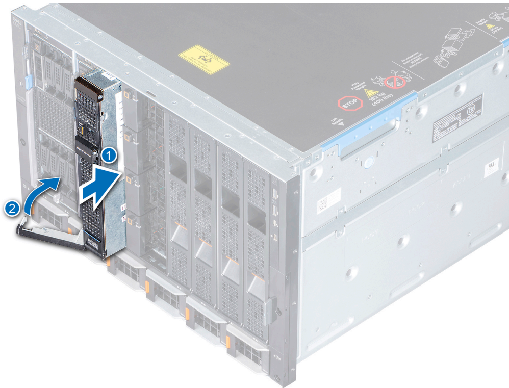
그림 19 . 엔클로저에 스토리지 슬레드 설치
