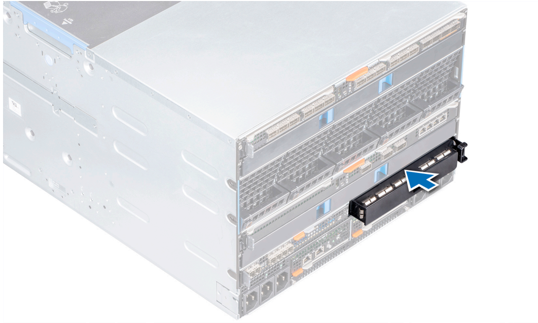
그림 33. 패브릭 C 슬롯에 보호물 설치
