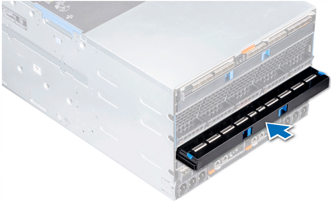
그림 29. 패브릭 A 또는 B 슬롯에 보호물 설치
