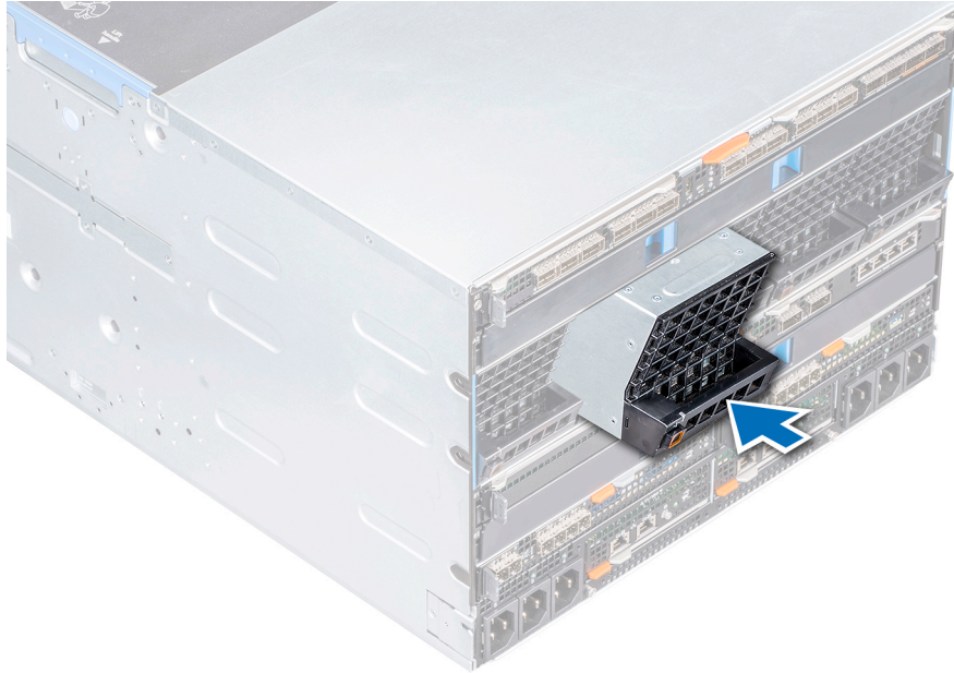
그림 23. 후면 팬 모듈 설치
