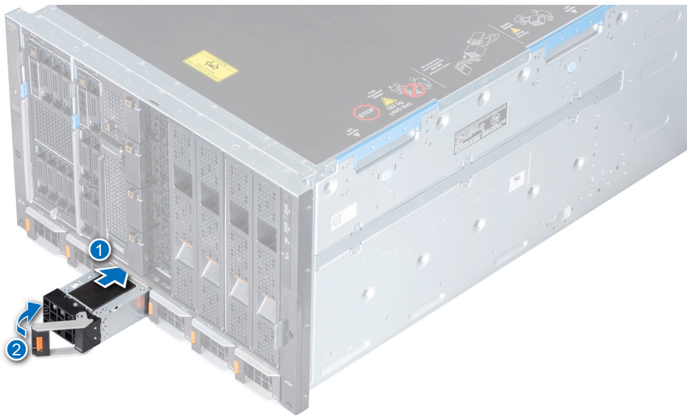
図 25. 電源装置ユニットの取り付け
