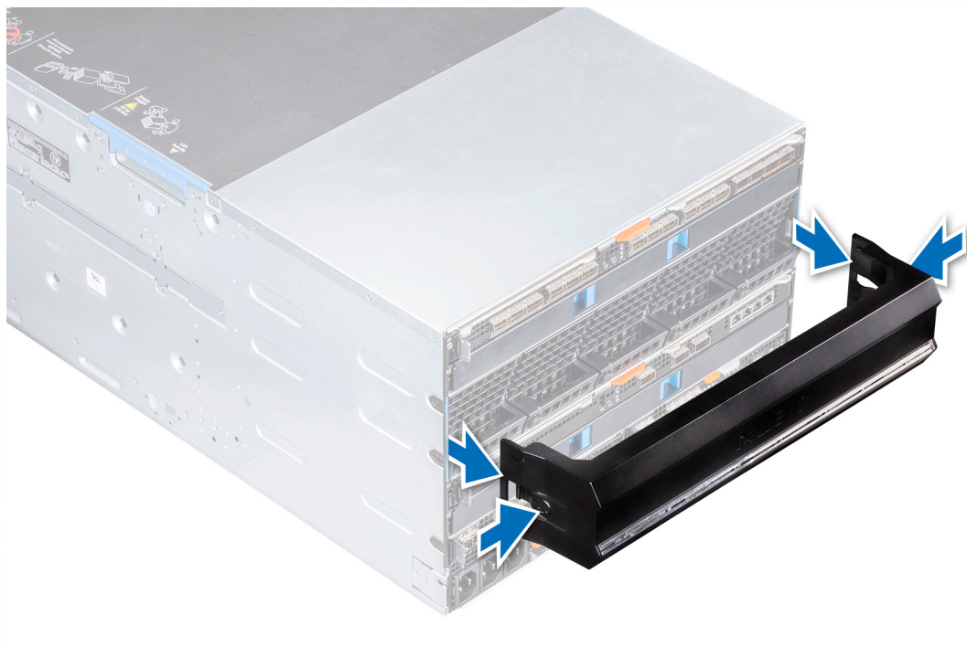
図 26. エアーバッフルの取り外し
