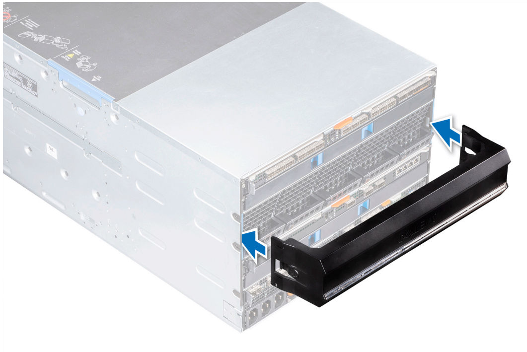
図 27. エアーバッフルの取り付け
