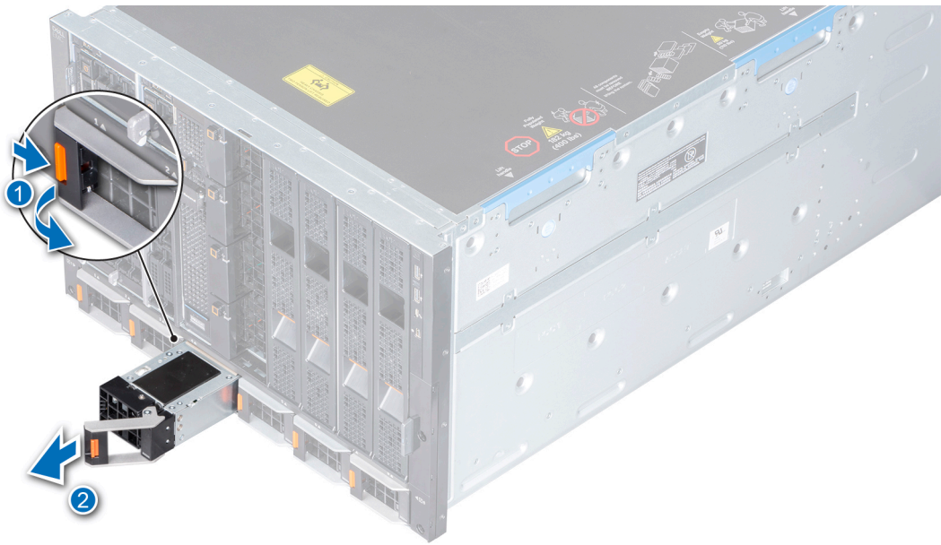
図 24. 電源装置ユニットの取り外し
