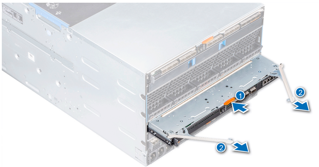
図 30. ファブリック A または B のスロットからのモジュールの取り外し
