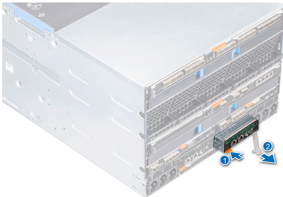
図 38. 管理モジュールの取り外し
