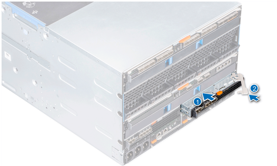
図 35. Fabric C スロットに MX7000 モジュールを取り付ける
