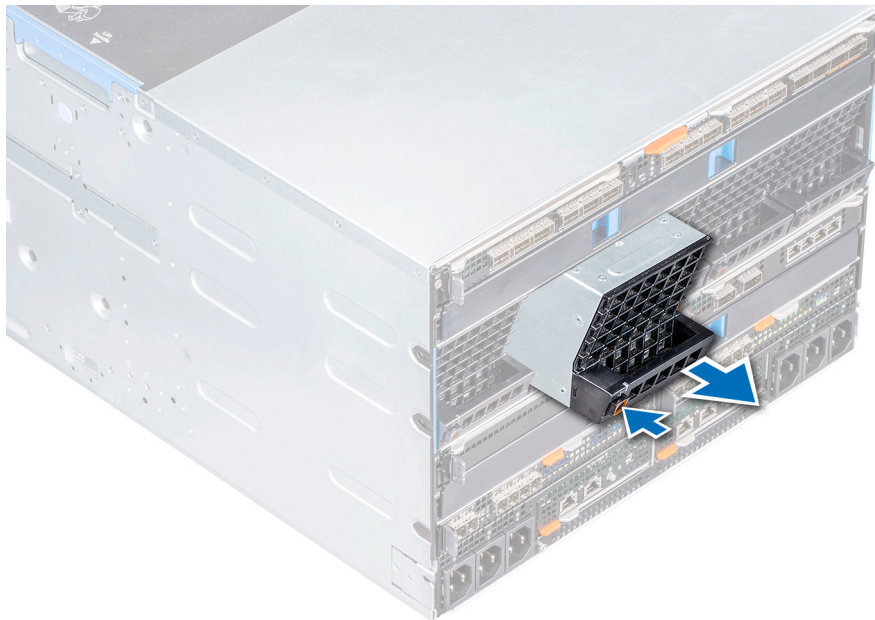
図 22. 背面ファン モジュールの取り外し
