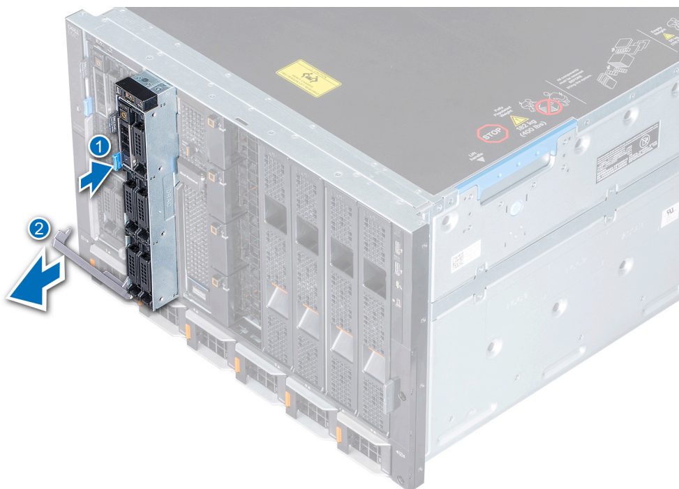
図 16. シングル幅コンピューティング スレッドのエンクロージャからの取り外し
