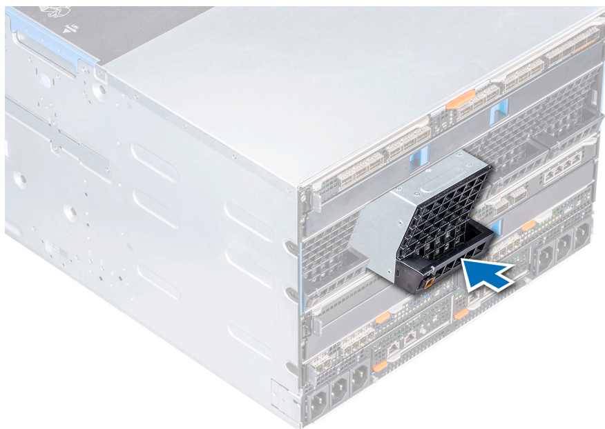
図 23. 背面ファン モジュールの取り付け
