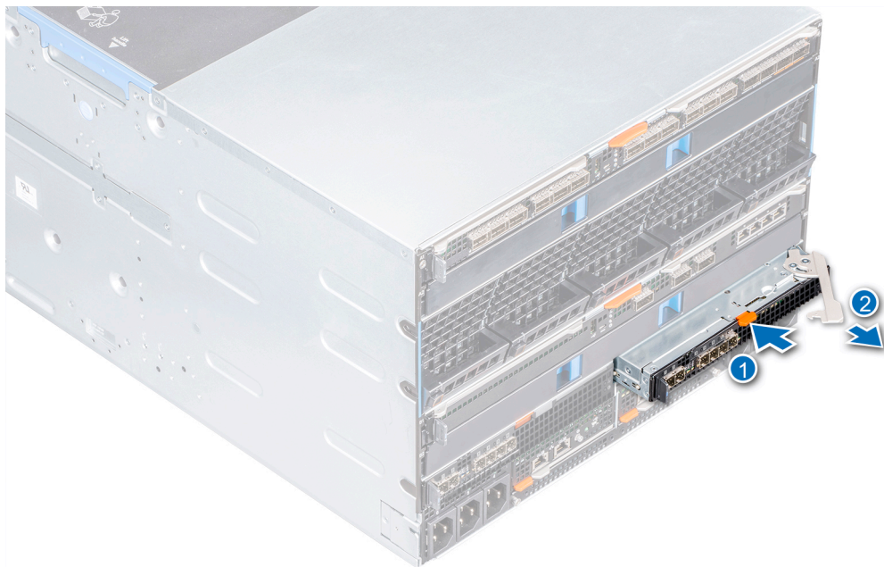
図 34. Fabric C スロットから MX7000 モジュールを取り外す
