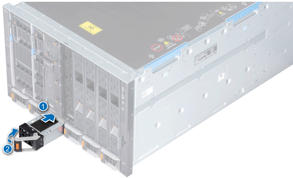
図 25. 電源装置ユニットの取り付け
