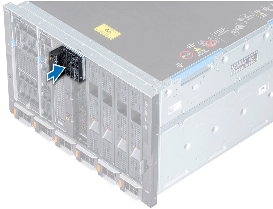
図 21. 前面ファン モジュールの取り付け
