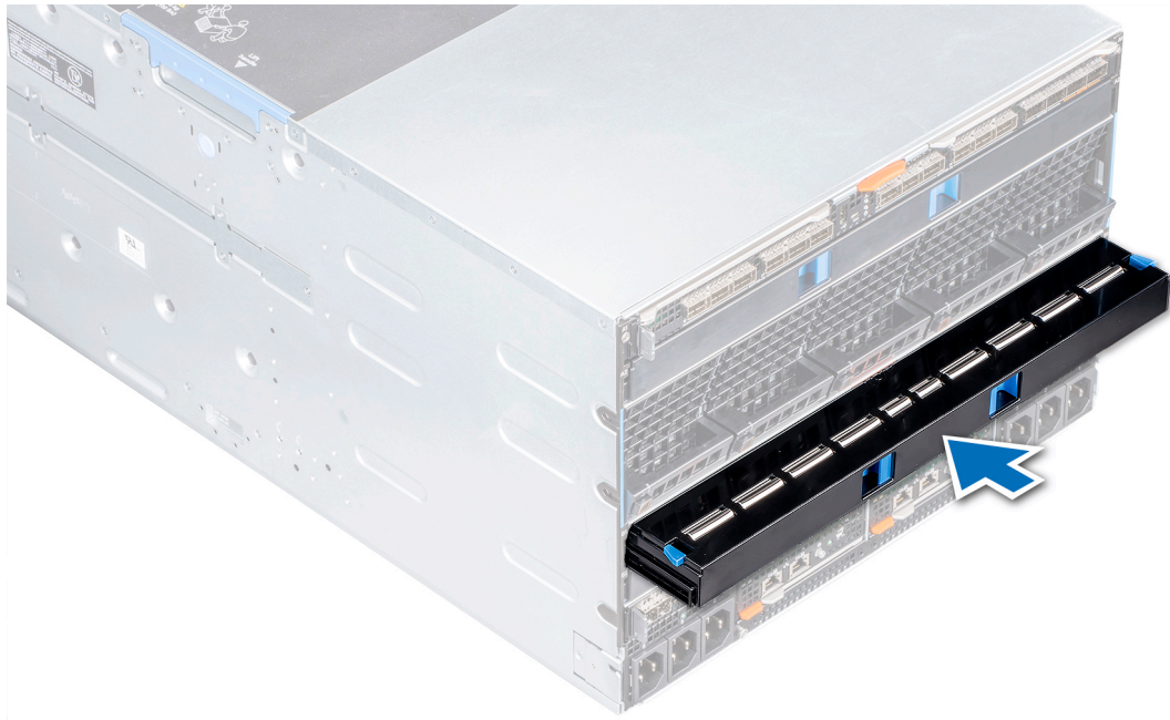
図 29. ファブリック A または B のスロットへのダミーの取り付け
