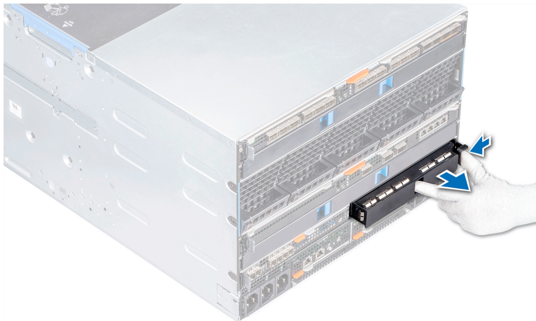
図 32. Fabric C スロットからダミーを取り外す
