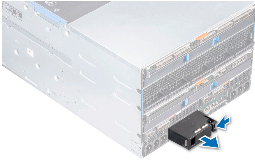
図 36. 管理モジュールのダミーの取り外し
