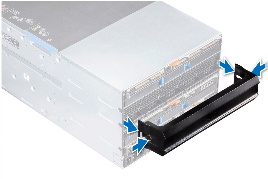
図 26. エアーバッフルの取り外し
