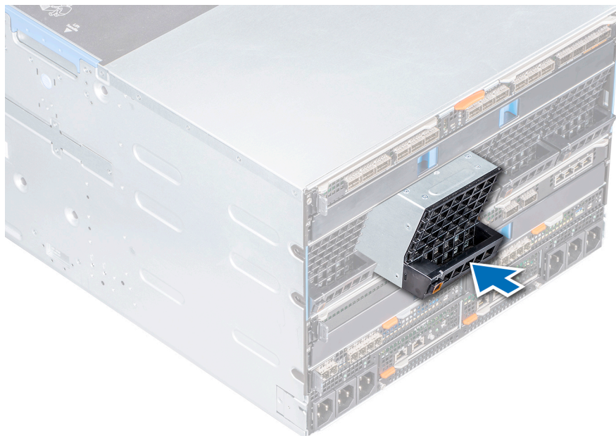
図 23. 背面ファン モジュールの取り付け
