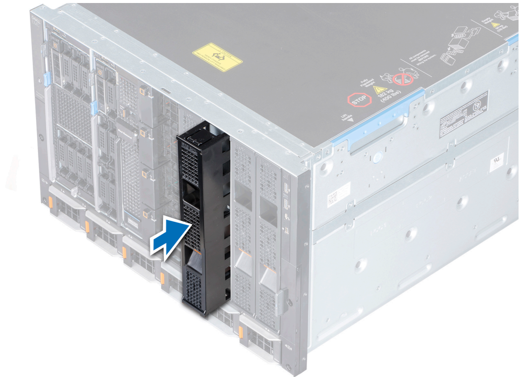
図 14. スレッド ダミーの取り付け
