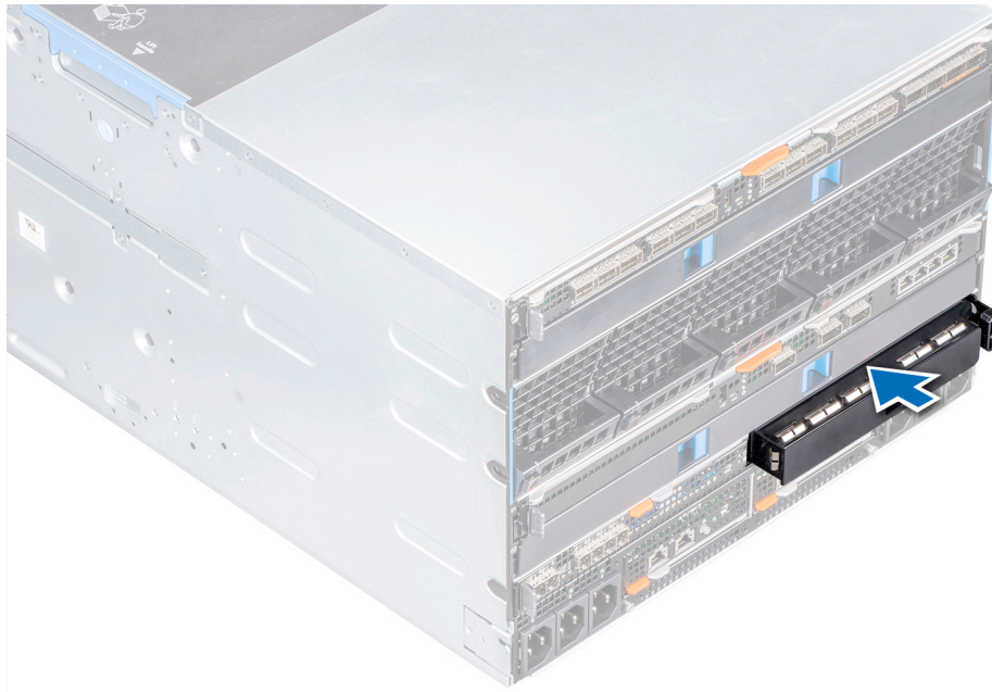
図 33. Fabric C スロットに MX5000s ダミーを取り付ける
