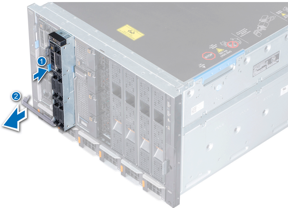
図 16. シングル幅コンピューティング スレッドのエンクロージャからの取り外し
