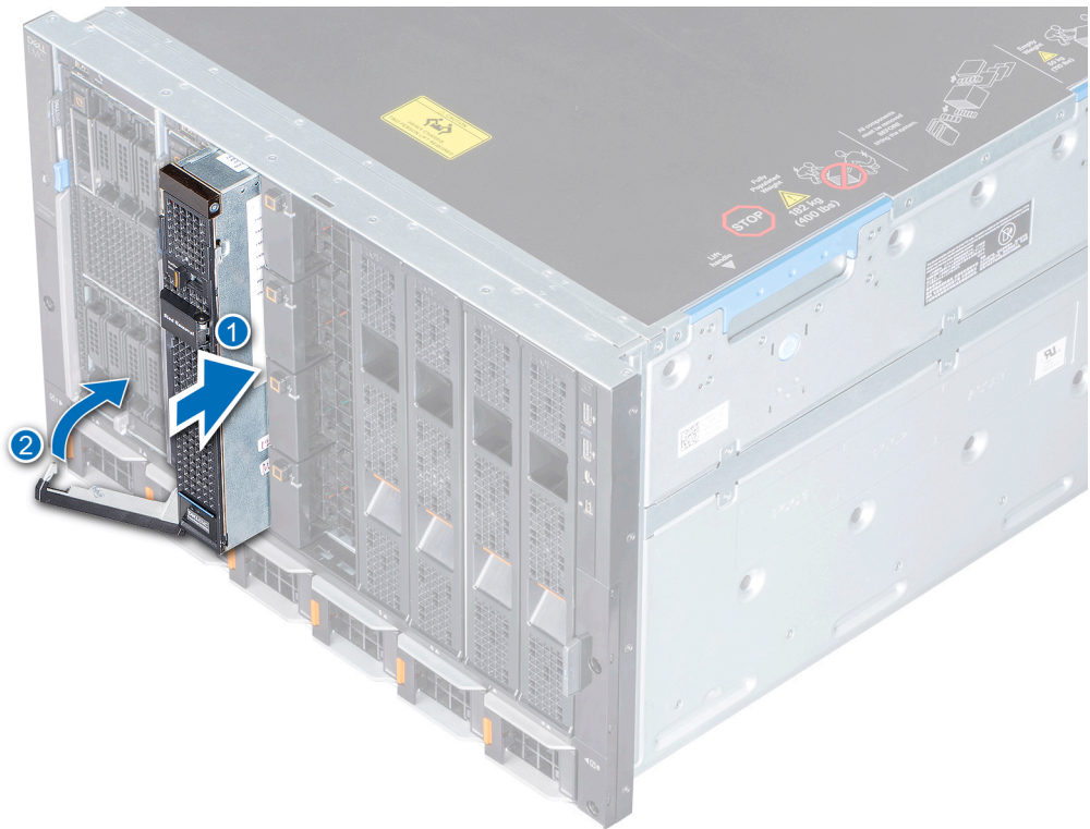
図 19. ストレージ スレッドのエンクロージャへの取り付け
