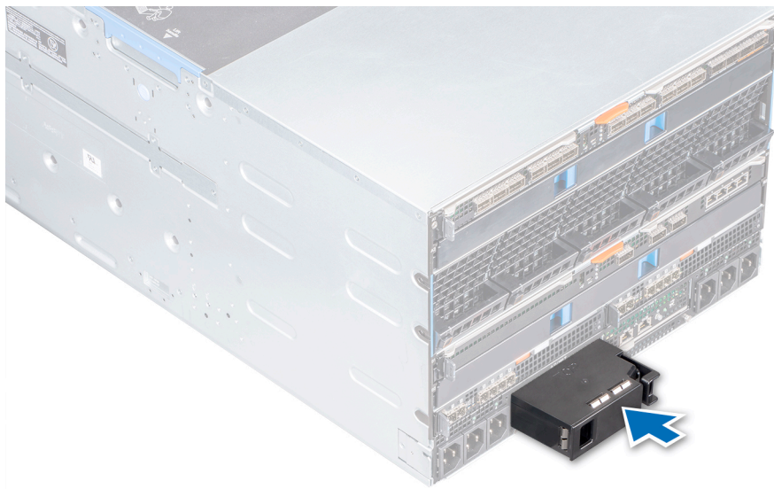
図 37. 管理モジュール ダミーの取り付け
