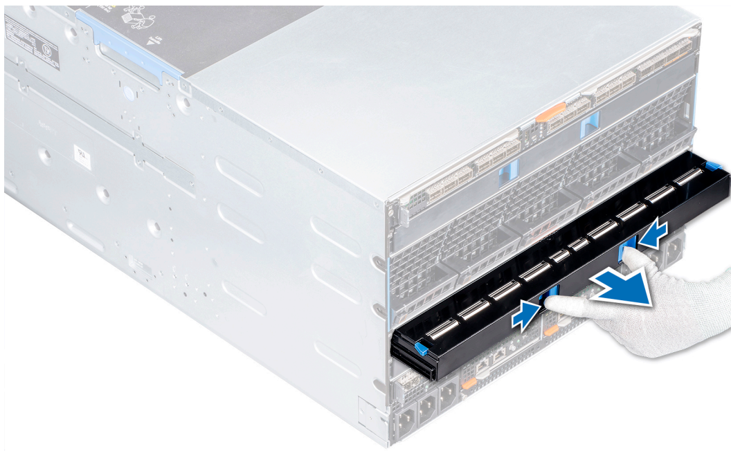
図 28. ファブリック A または B のスロットからのダミーの取り外し
