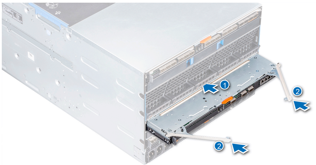
図 31. ファブリック A または B のスロットへのモジュールの取り付け
