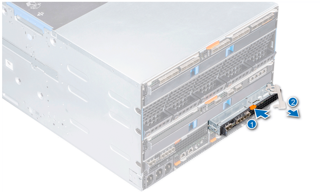
図 34. Fabric C スロットから MX7000 モジュールを取り外す
