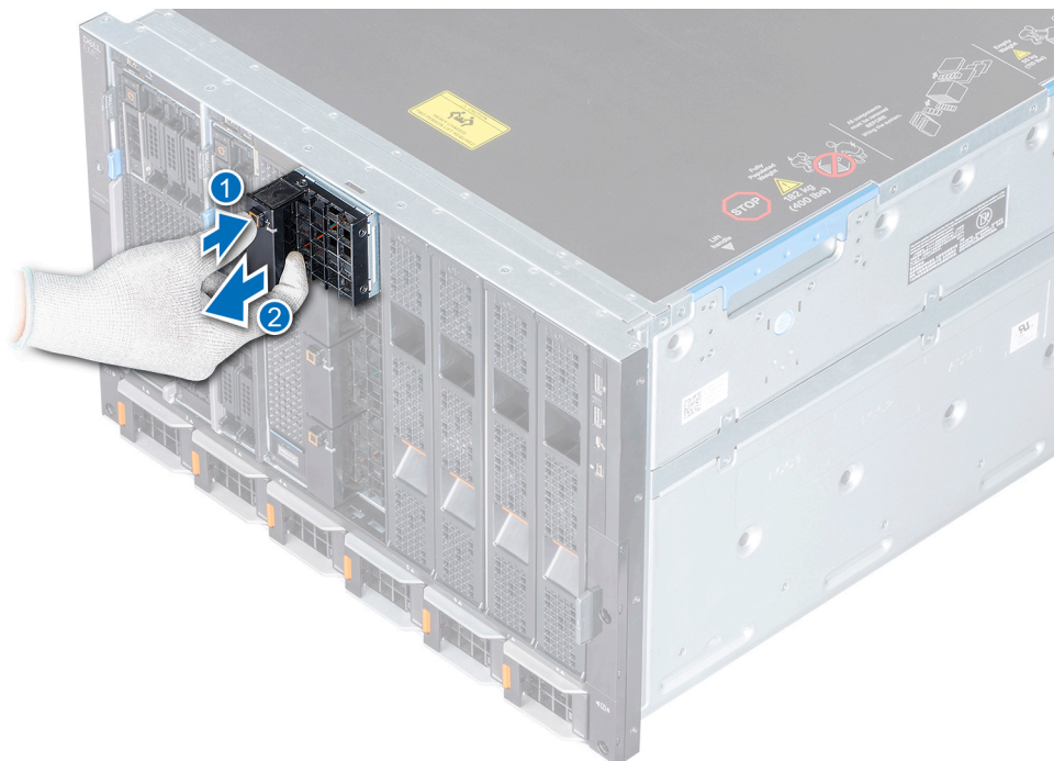
Figure 20. Retrait d'un module de ventilation avant
