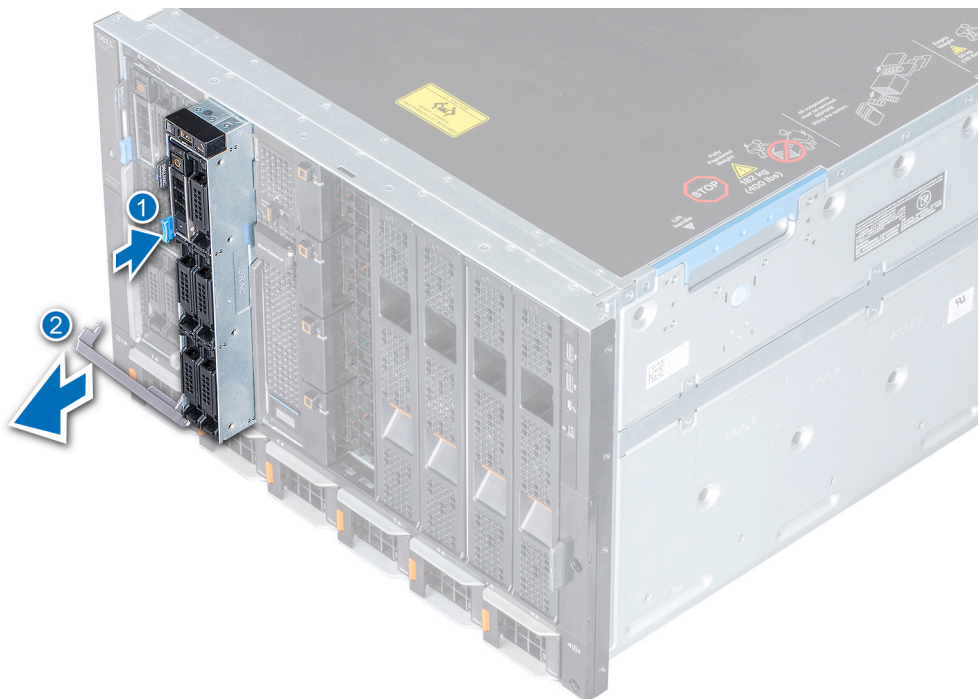
Figure 16. Retrait d'un module tiroir extractible de calcul simple-largeur du boîtier
