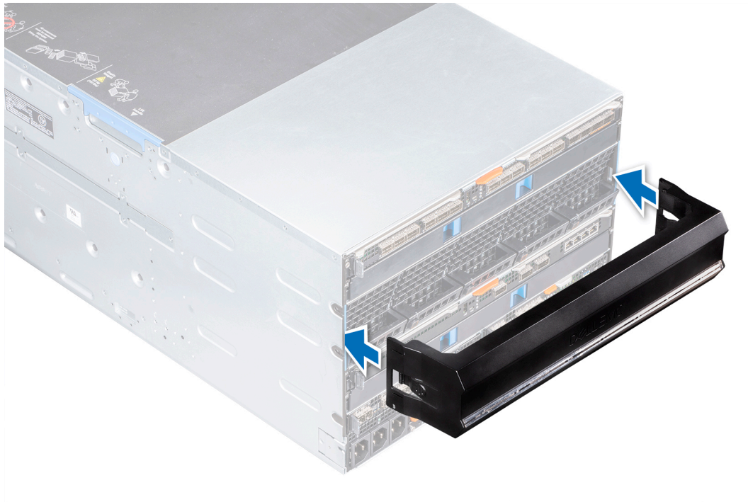
Figure 27. Installation du déflecteur d'air
