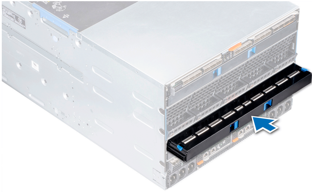
Figure 29. Installation d'un cache dans le logement de la structure A ou B
