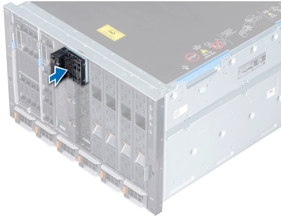
Figure 21. Installation du module de ventilation avant
