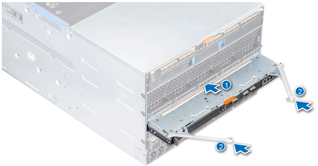
Figure 31. Installer un module dans le logement de la structure A ou B
