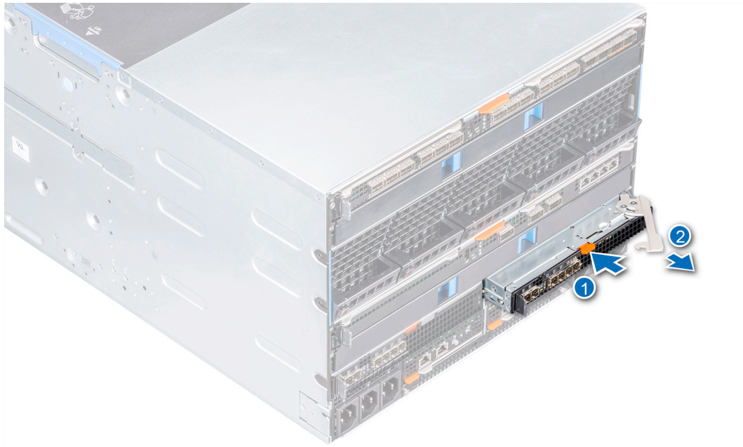
Figure 34. Retrait d'un module MX7000 depuis un logement de Fabric C
