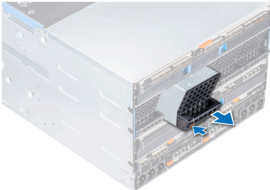
Figure 22. Retrait d'un module de ventilation arrière
