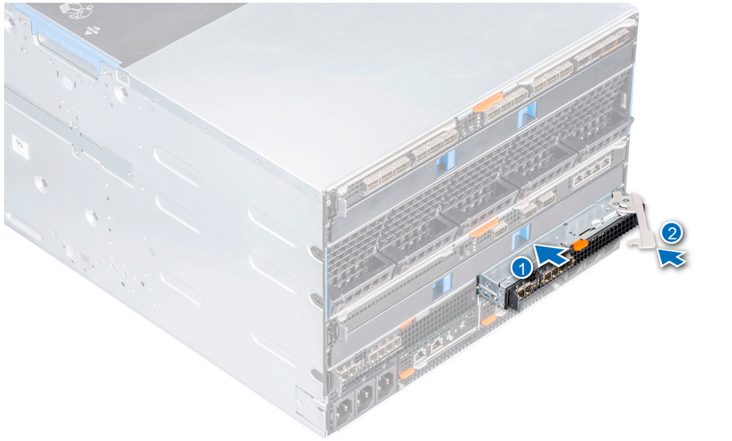
Figure 35. Installation d'un module MX7000 dans un logement de Fabric C
