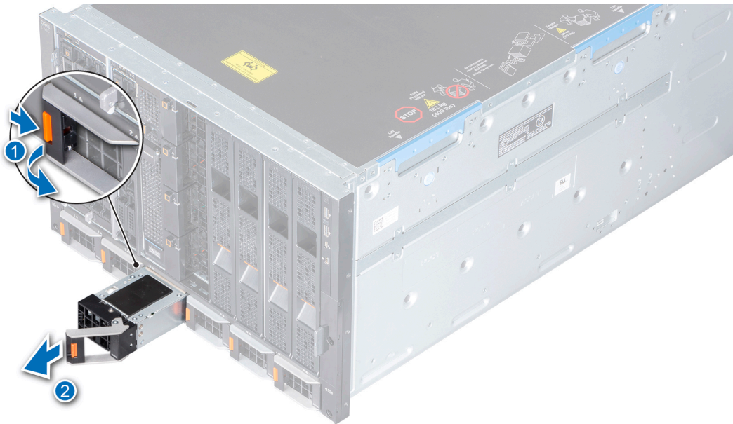
Figure 24. Retrait d'une unité d'alimentation
