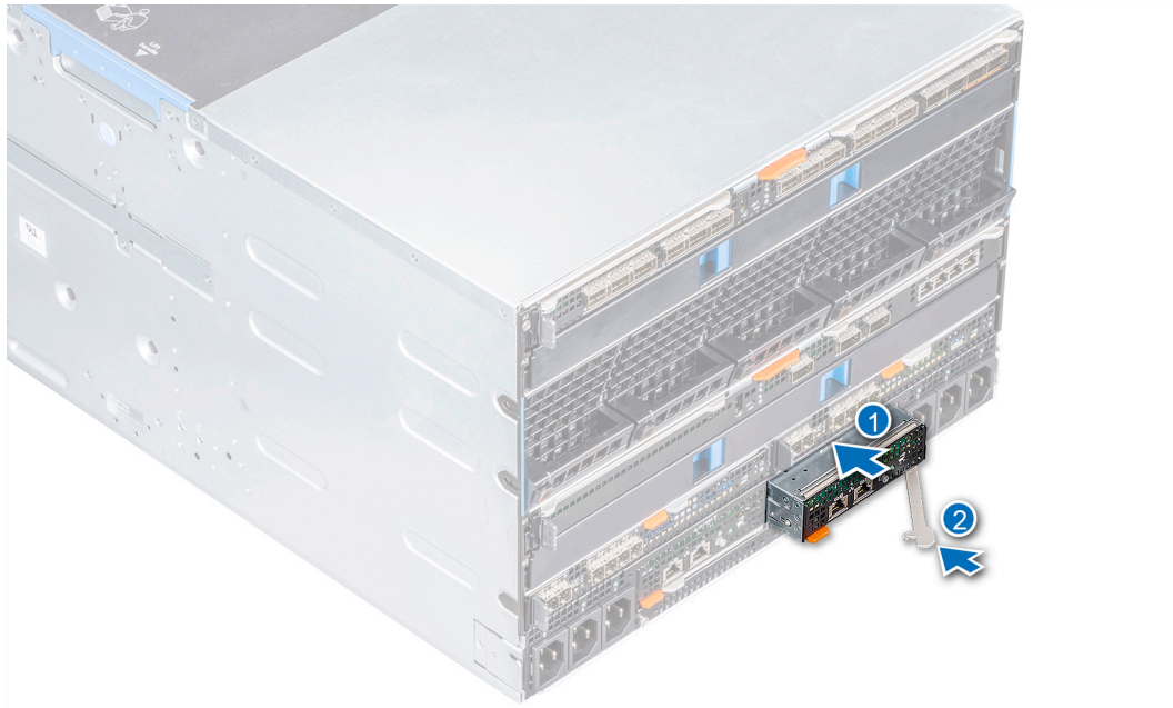
Ilustración 40. Instalación de un módulo de administración
