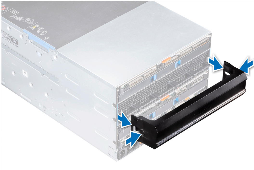
Ilustración 26. Extracción del deflector de aire
