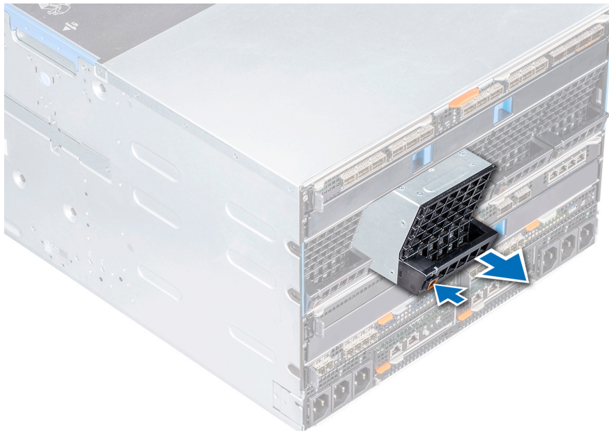
Ilustración 22. Extracción de un módulo de ventilador trasero
