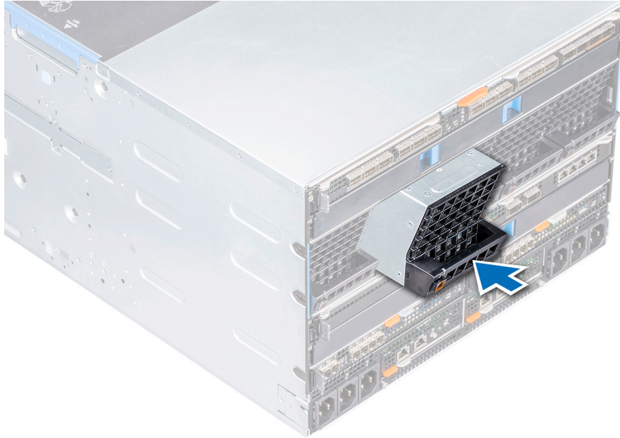
Ilustración 23. Instalación de un módulo de ventilador trasero
