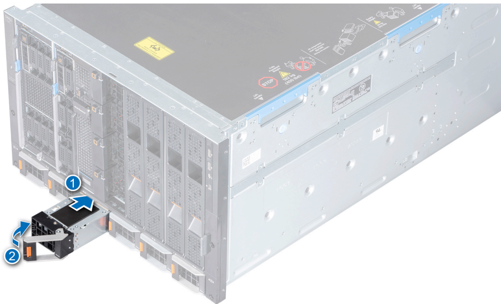
Ilustración 25. Instalación de una unidad de suministro de energía
