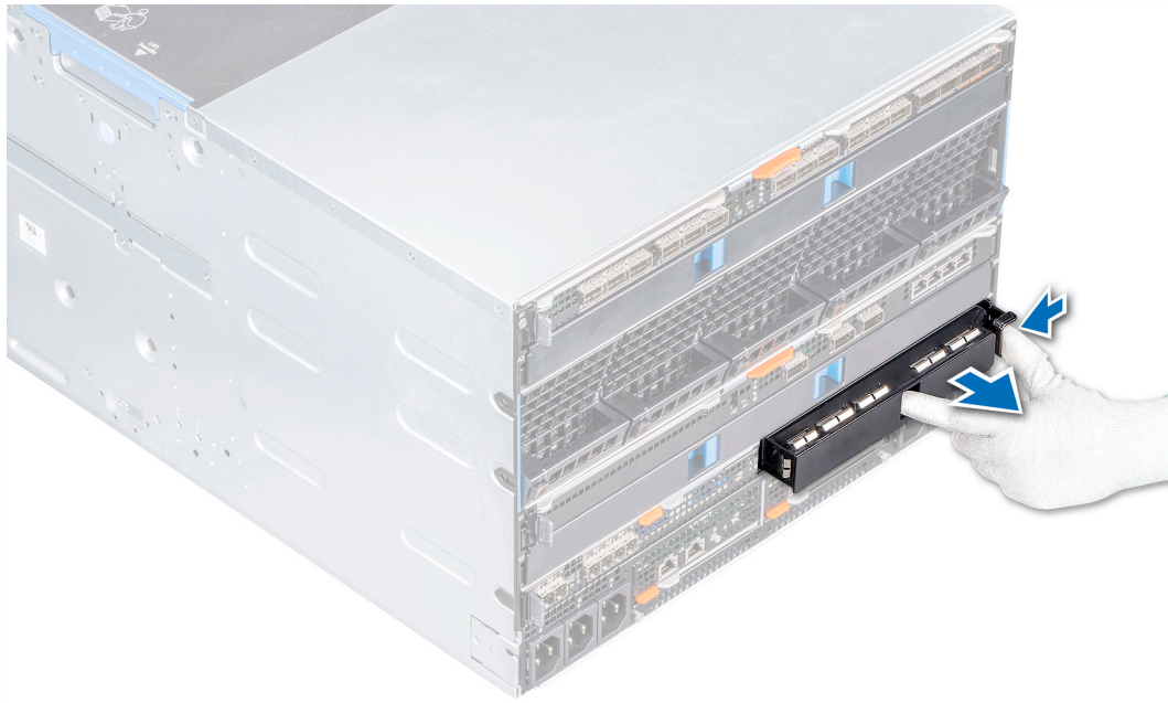
Ilustración 32. Extracción de una unidad de relleno de la ranura de la red Fabric C
