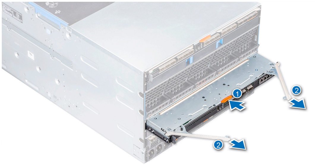
Ilustración 30. Extracción de un módulo de ranura de la Fabric A o B
