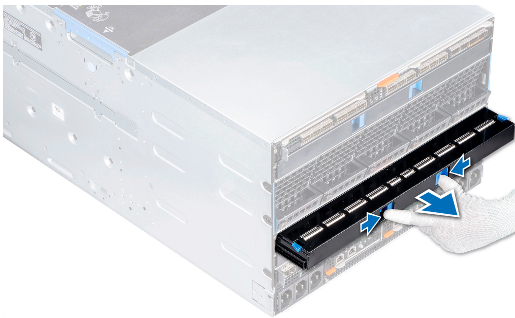
Ilustración 28. Extracción de un panel de relleno de ranura de la Fabric A o B
