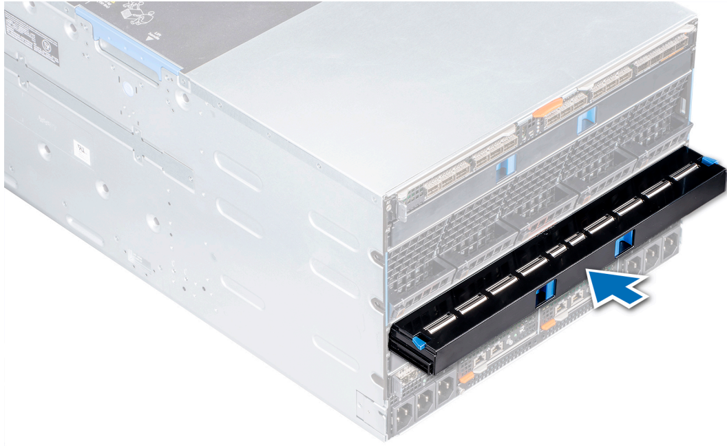
Ilustración 29. Instalación de un panel de relleno en ranura de la Fabric A o B
