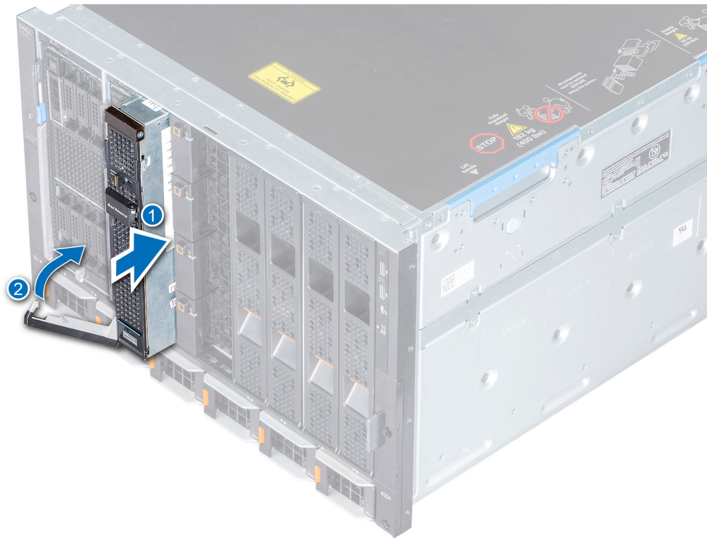
Ilustración 19. Instalación de un sled de almacenamiento en el gabinete
