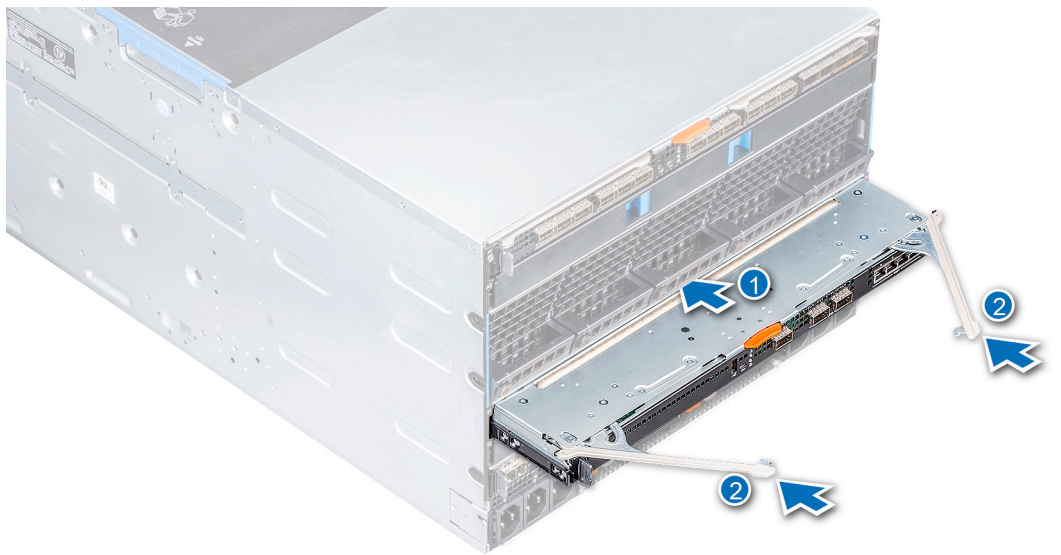
Ilustración 31. Instalación de un módulo en ranura de la Fabric A o B
