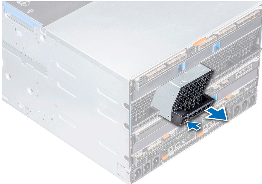
Ilustración 22. Extracción de un módulo de ventilador trasero
