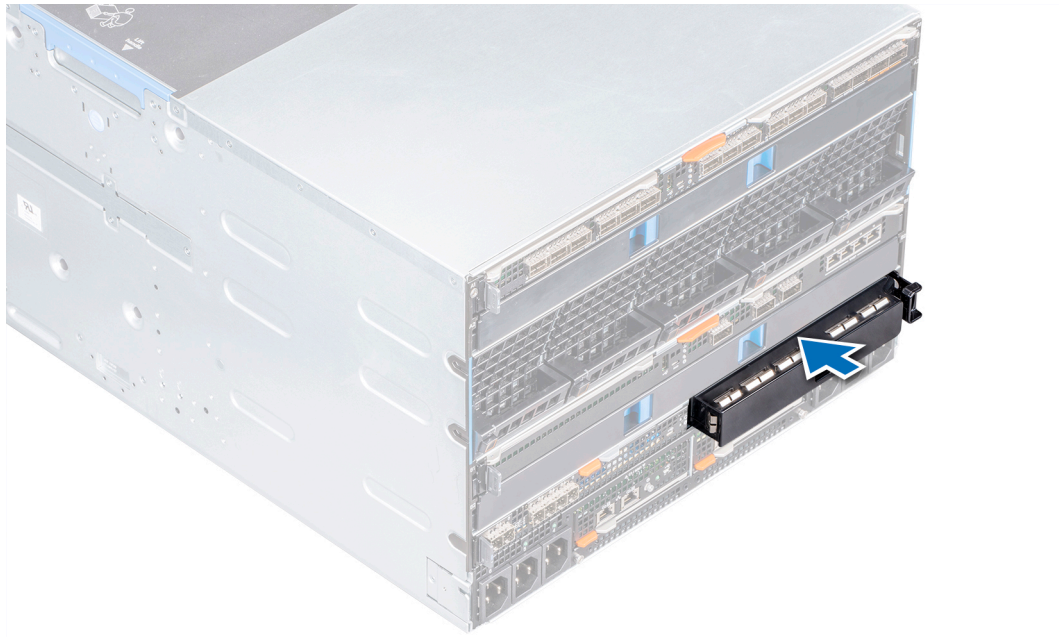
Ilustración 33. Instalación de una unidad de relleno en la ranura de la red Fabric C
