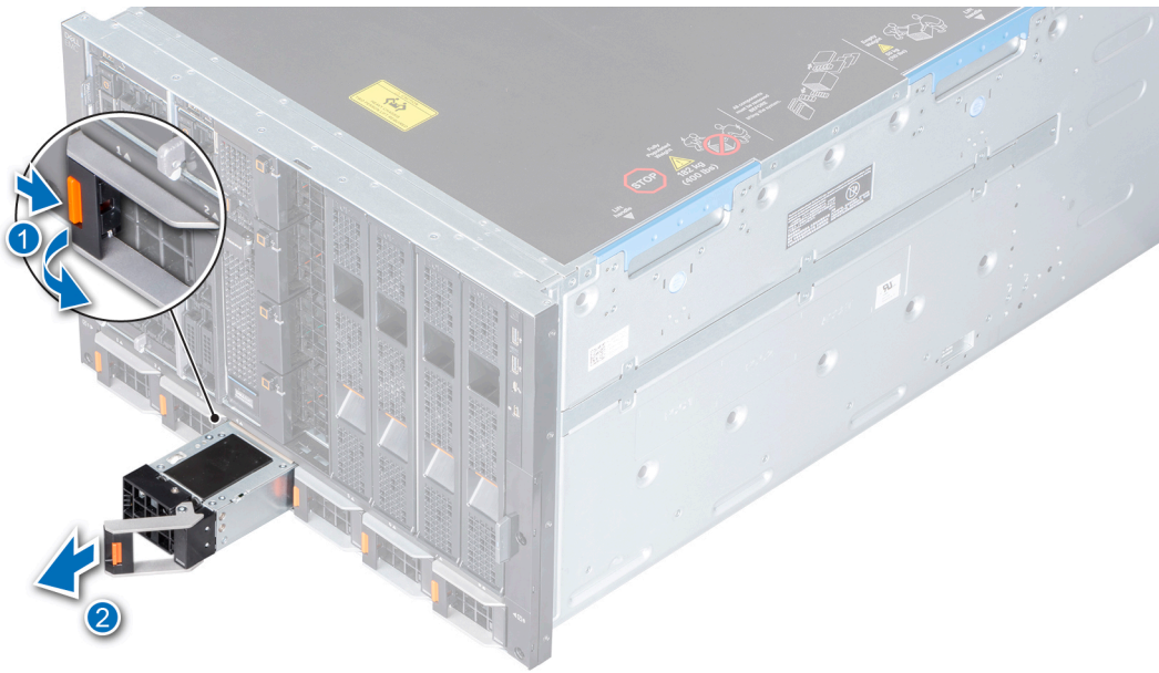
Ilustración 24. Extracción de una unidad de fuente de alimentación
