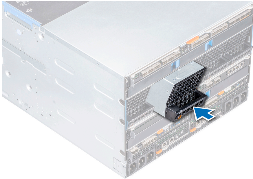
Figure 23. Installing a rear fan module
