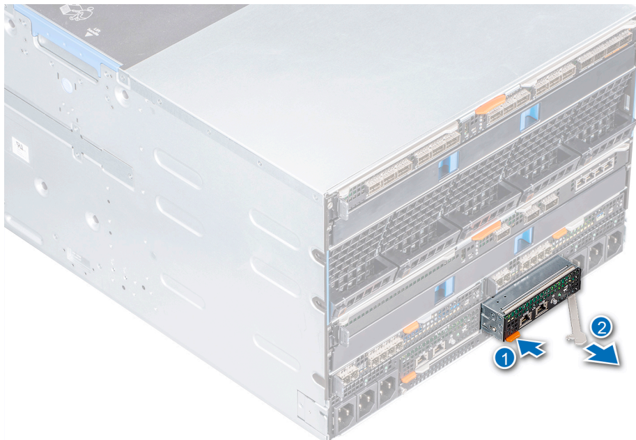
Abbildung 38. Entfernen eines Verwaltungsmoduls
