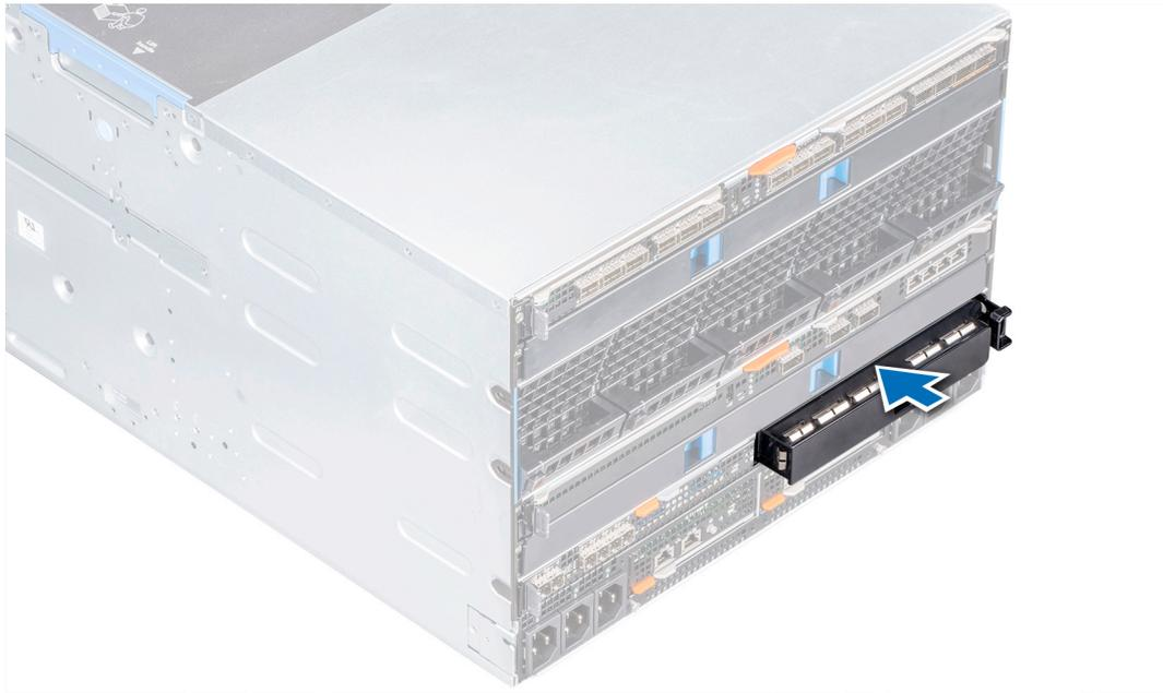
그림 23. 패브릭 C 슬롯에 보호물 설치
