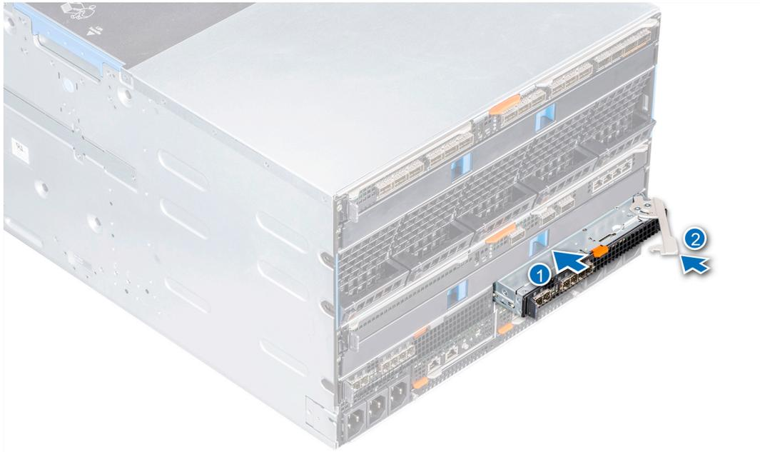
그림 25 . 패브릭 C 슬롯에 MX5016 모듈 설치
