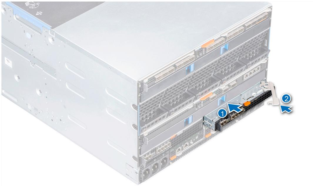
Figure 25. Installation d'un module MX5016s dans un logement de Fabric C
