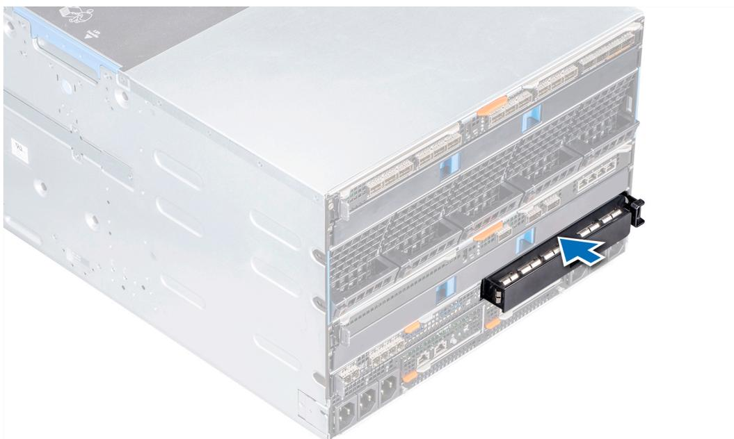
Figure 23. Installation d'un cache dans un logement du Fabric C
