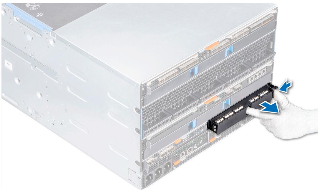
Figure 22. Retrait d'un cache d'un logement de Fabric C
