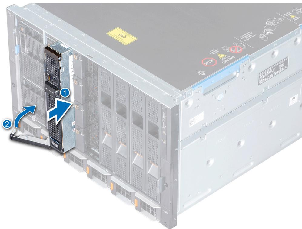
Figure 9. Installation du chariot dans le boîtier
