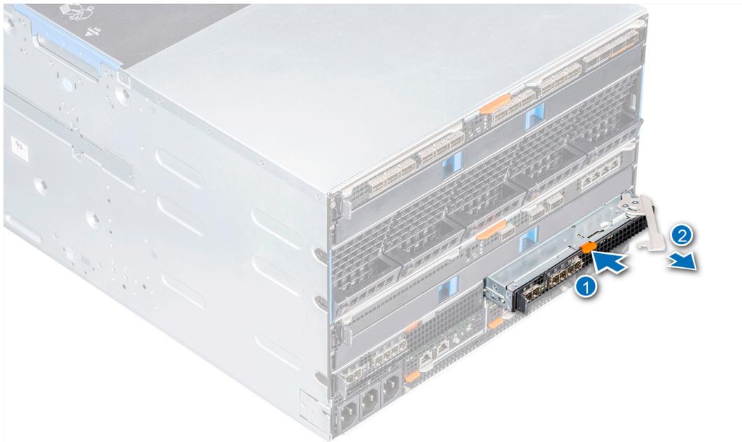
Figure 24. Retrait d'un module MX5016s depuis un logement de Fabric C
