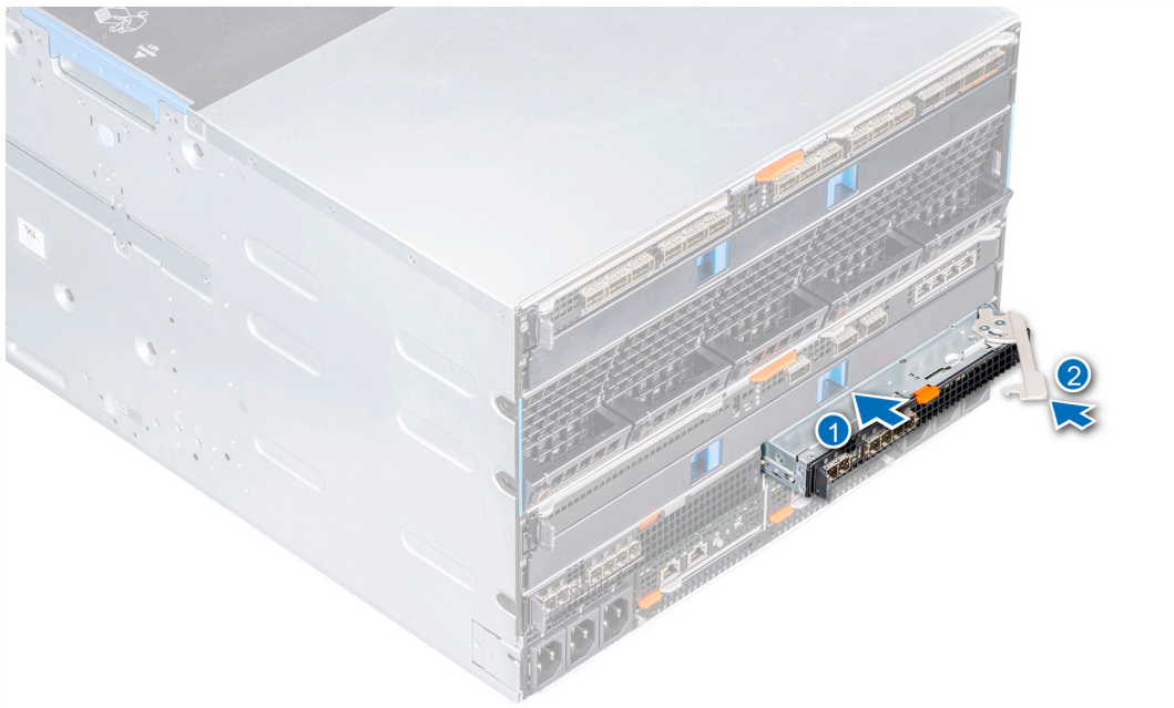
图 25: 在结构 C 插槽中安装 MX5016s 模块
