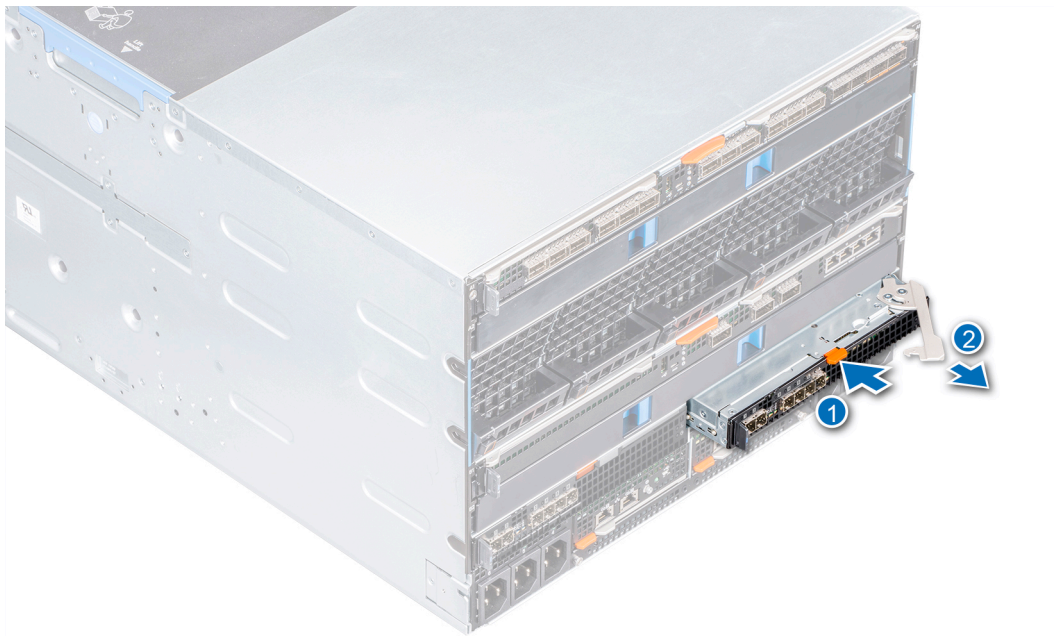
Figura 24. Extracción de un módulo MX5016s de la ranura de la red Fabric C
