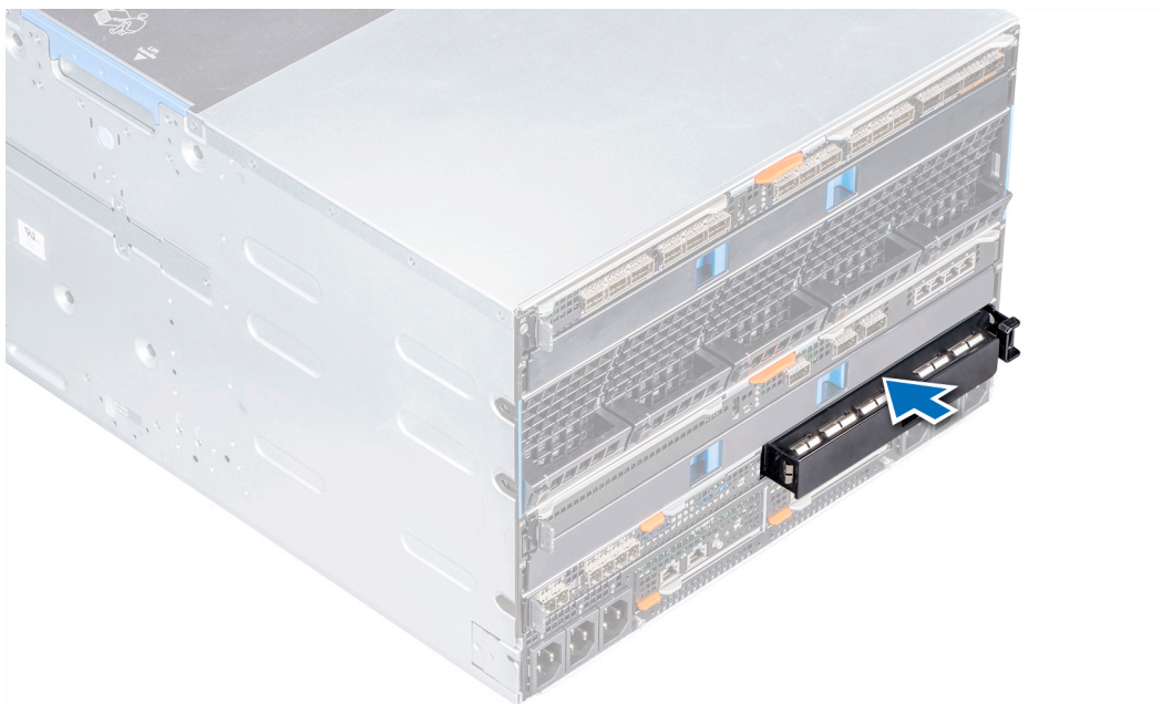
Figura 23. Instalación de una unidad de relleno en la ranura de la red Fabric C
