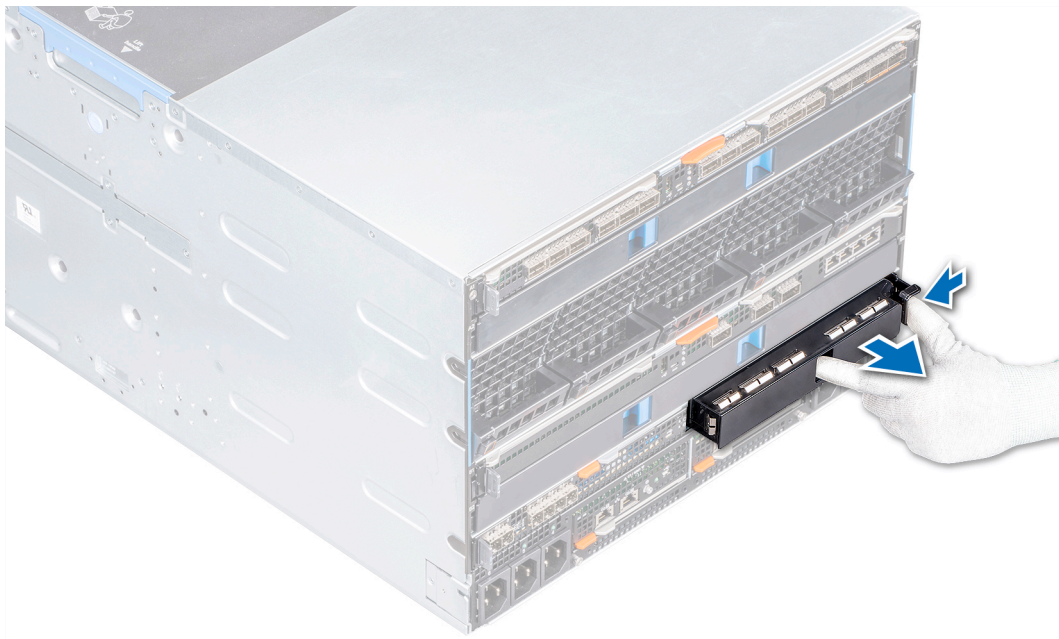
Figura 22. Extracción de una unidad de relleno de la ranura de la red Fabric C
