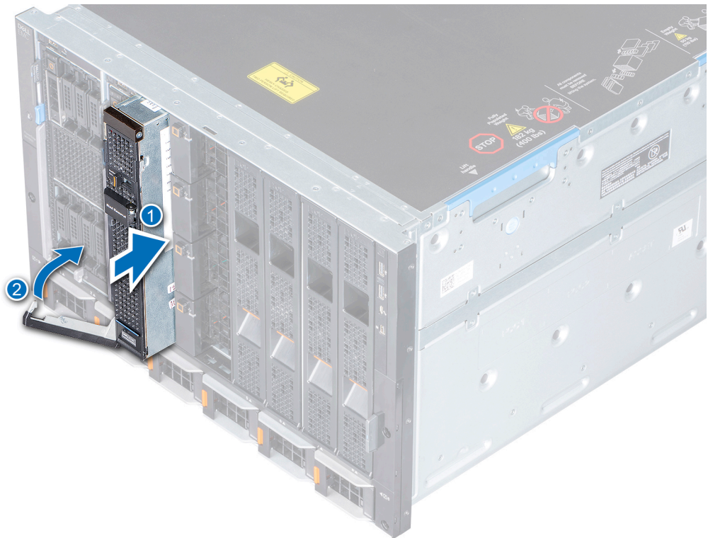
Abbildung 9. Einsetzen des Schlittens in das Gehäuse
