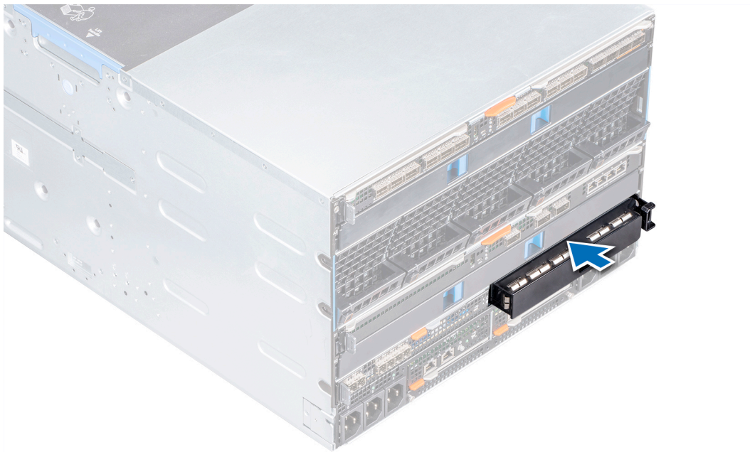
Abbildung 23. Einsetzen eines Platzhalters in den Fabric-C-Steckplatz
