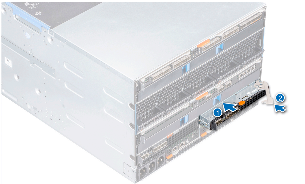
Abbildung 25. Einsetzen eines MX5016s-Moduls in einen Fabric-C-Steckplatz
