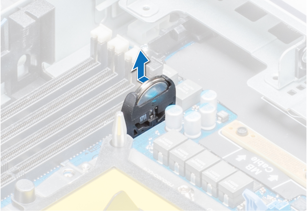
Rakam 46. Sistem pilinin çıkartılması
