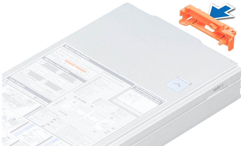
그림 8. I/O 커넥터 덮개 설치
