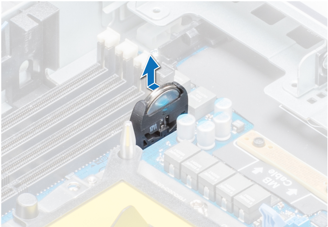
図 46. システムバッテリーの取り外し
