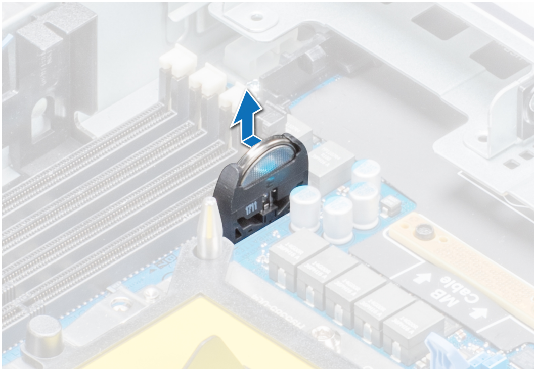
図 46. システムバッテリーの取り外し
