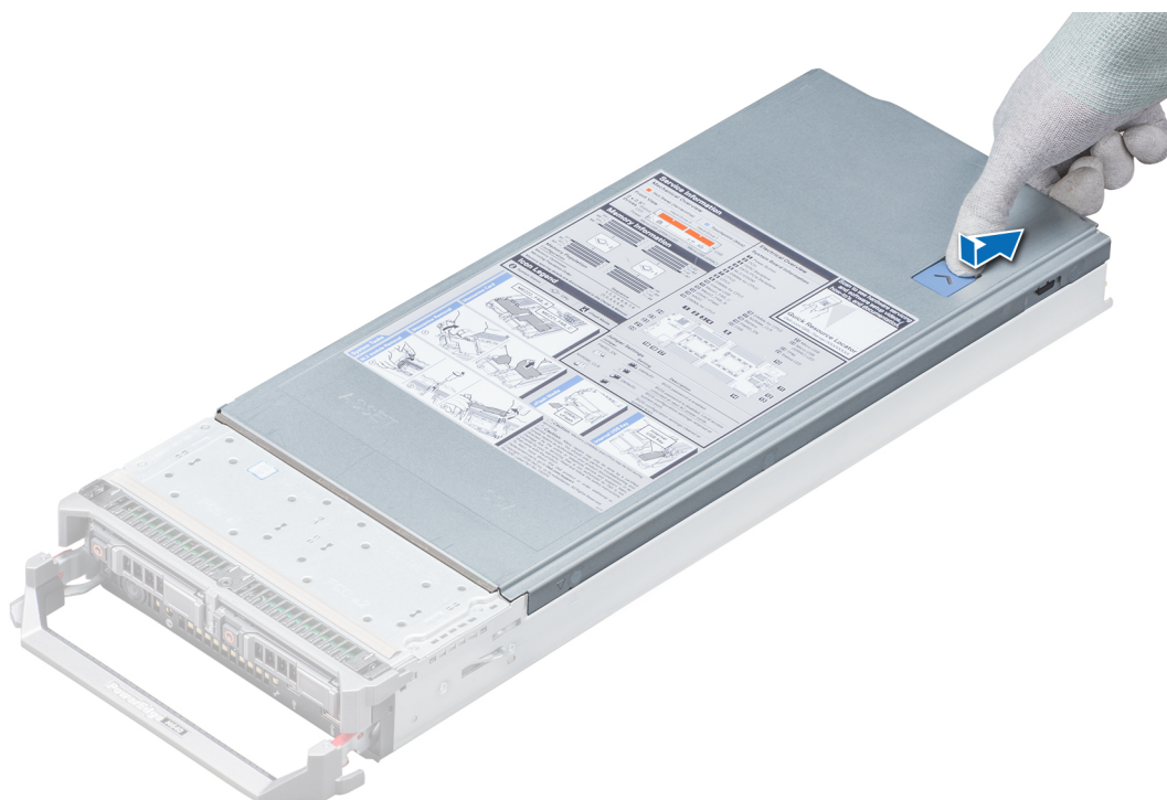
図 12. システムカバーの取り外し
