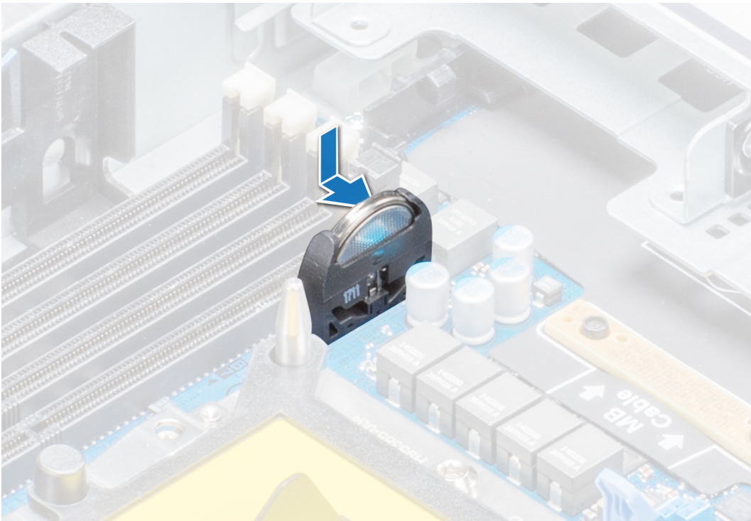
Ilustración 47. Instalación de la batería del sistema
