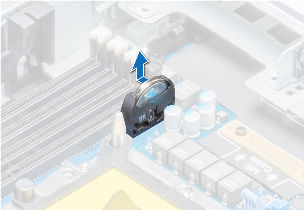
Ilustración 46. Extracción de la batería del sistema
