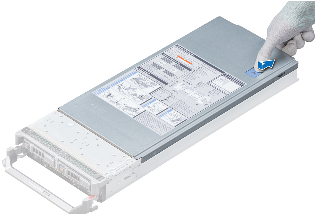
Ilustración 12. Extracción de la cubierta del sistema
