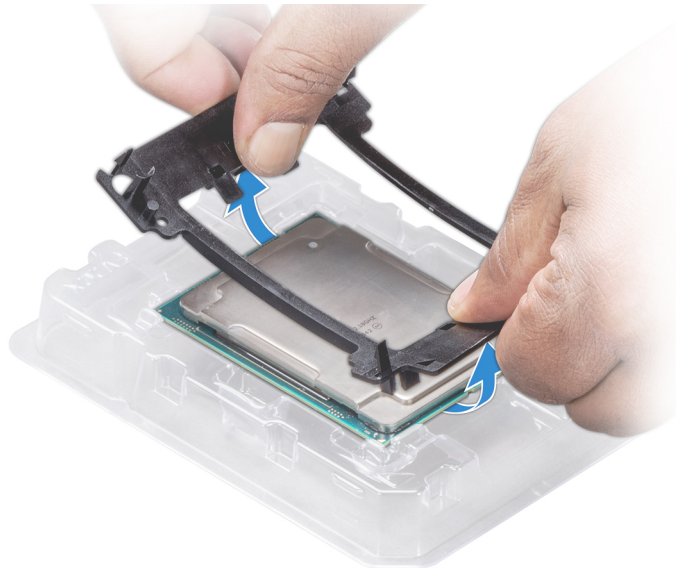
Abbildung 33. Entfernen der Prozessorhalterung
