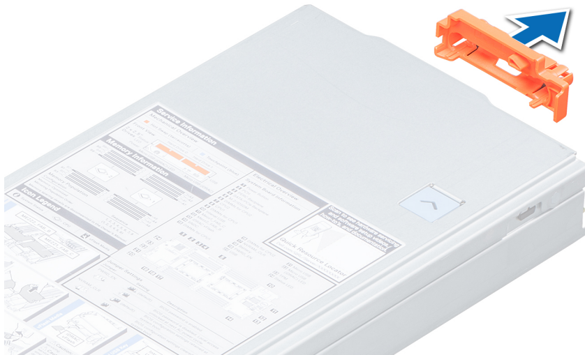
Abbildung 9. Entfernen der E/A-Anschlussabdeckung
