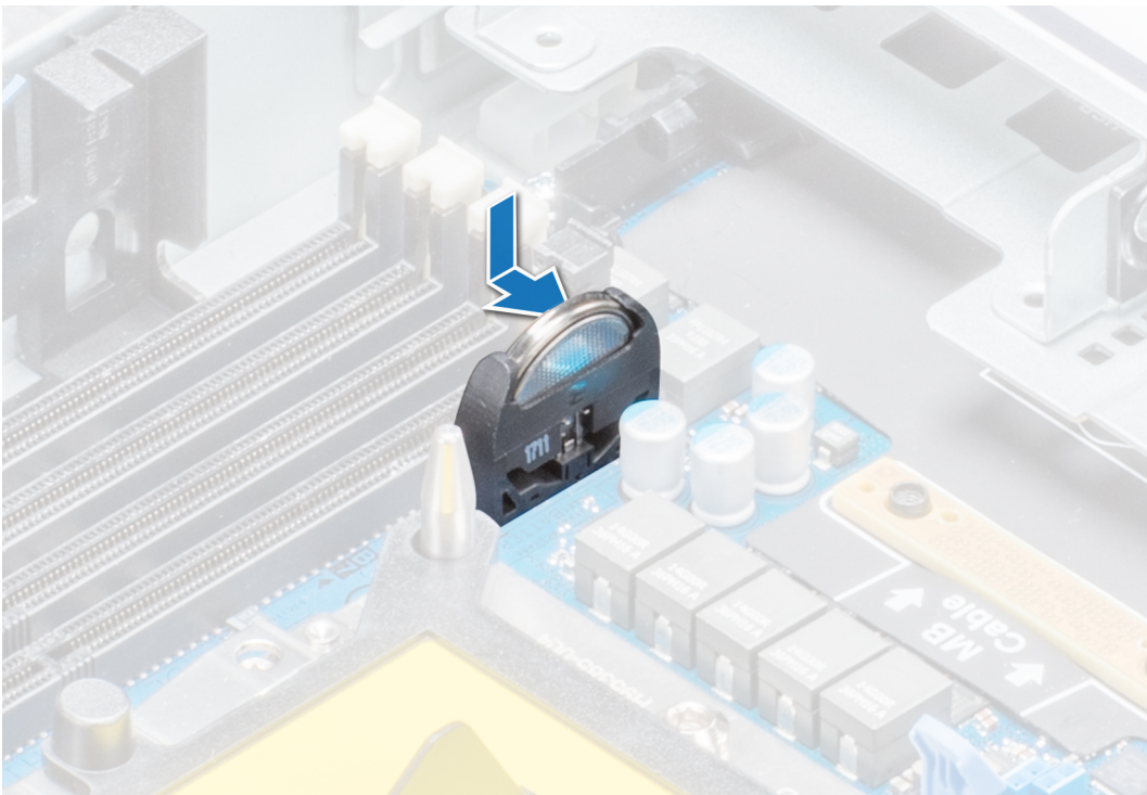
Abbildung 47. Installieren der Systembatterie
