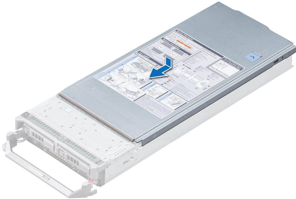
图 13: 安装系统护盖
